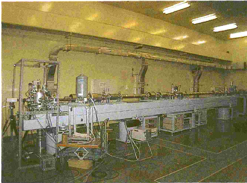
(a) 軽イオンマイクロビーム形成装置 (温度対策前)
