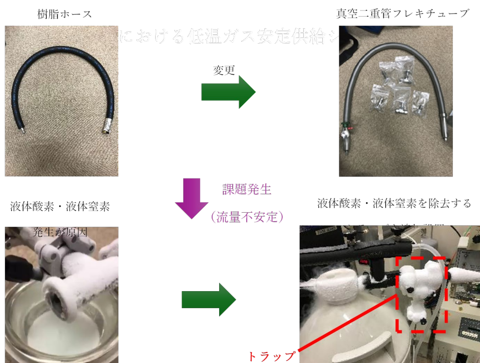
図 18. 低温ガス用配管と熱交換トラップ設置図
