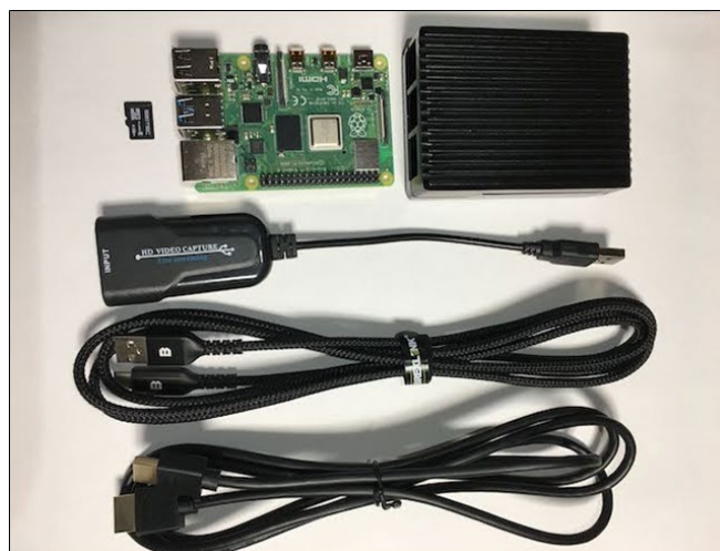
図 24. 市販の KVM over IP に比べて、非常に安価に構築できるラズベリーパイを用いた遠隔操作システム。9 大学 11 名の技術職員からなる大学技術職員組織研究会遠隔操作プロジェクト」（2020～2021 年で開発）
