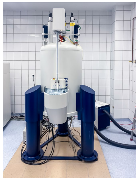
図 1. 核磁気共鳴分光を行う専用分析装置である核磁気共鳴分光計（NMR 分光装置）の例。
