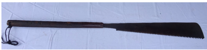
上：【写真 8】伐採用の鋸（長さ 126cm/刃渡り 84cm）。「土佐」の銘がある。
