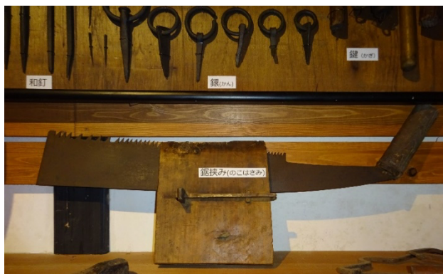
【写真 7】手前が目立ての時に使うノコバサミ。奥に見えるのがテンコロで鋸とも呼称される。砥部むかしのくらし館蔵。
