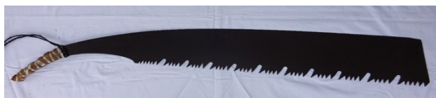
【写真 10】戦後に開発された改良鋸（長さ 105cm/刃渡り 81cm）。「土佐大柘町 ○高小松高重請合」の陰刻がある。砥部むかしのくらし館蔵。
