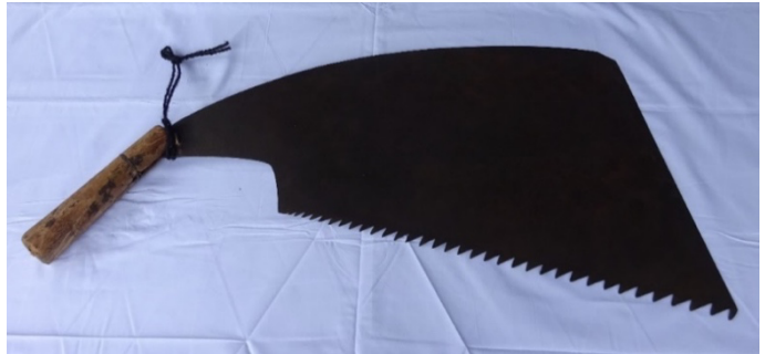
【写真 13】製材に用いられたオガ（長さ 93cm/刃渡り 62cm/刃先 41cm）。砥部むかしのくらし館蔵。
