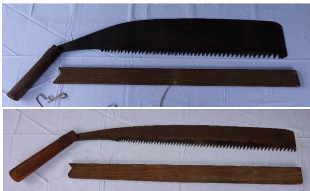
上：【写真 11】伐採用の鋸（長さ 81cm/刃渡り 58cm/刃先 13cm）。 下：【写真 12】幅の狭い鋸（長さ 73cm/刃渡り 46cm/刃先 6cm）。 砥部むかしのくらし館蔵。
