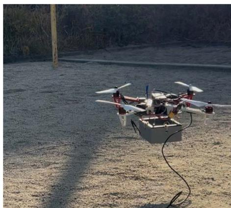
図 7 負荷状態の飛行（荷台のみ）
