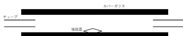
（図1）結晶観察セルの概略図
