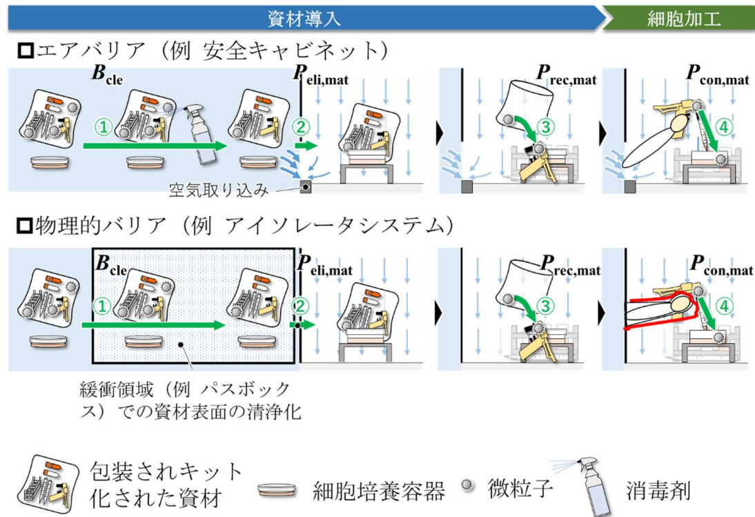
図 3.1 資材外装由来の製品への微生物混入推定機序. ①は清浄化後に微生物が残存する確率( B_{\text{cle}} )を示す. ②は資材外装残存微粒子が CPZ 内へ侵入する確率( P_{\text{eli,mat}} )を示す. ③は資材外装残存微粒子が資材へ再付着する確率( P_{\text{rec,mat}} )を示す. ④は資材から落下した微粒子が製品内へ混入する確率( P_{\text{con,mat}} )を示す. なお、微粒子は一定確率 ( f ) で微生物とする。
