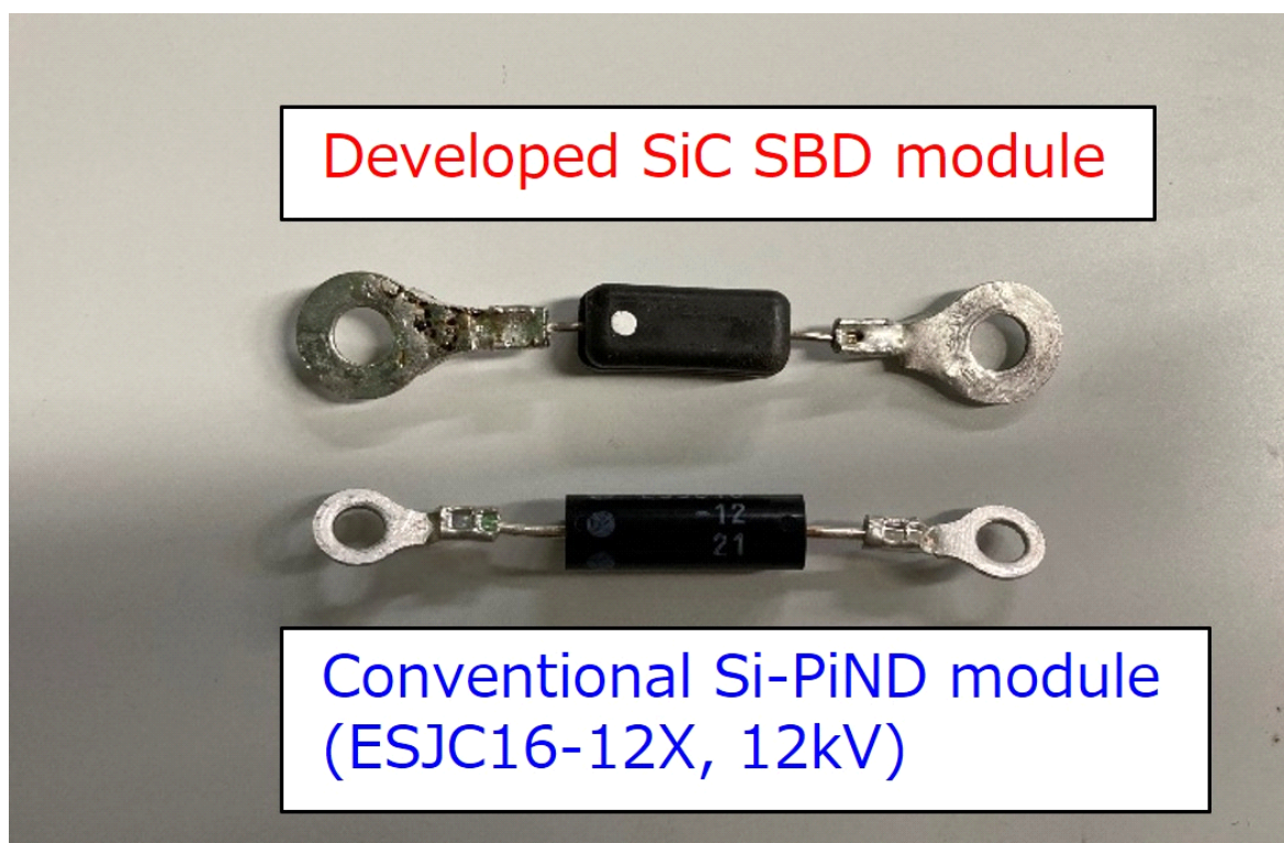
図 2.17 開発した SiC SBD モジュールと従来品の Si PiND モジュール
