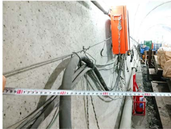
写真-4.5 壁面の配線や配管による誤差
