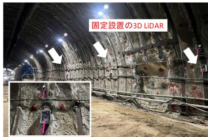
図-4.8 トンネル壁面に設置した 3D LiDAR
