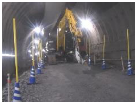
写真-4.3 狭所の走行試験 (通路幅約 4.0 m)
