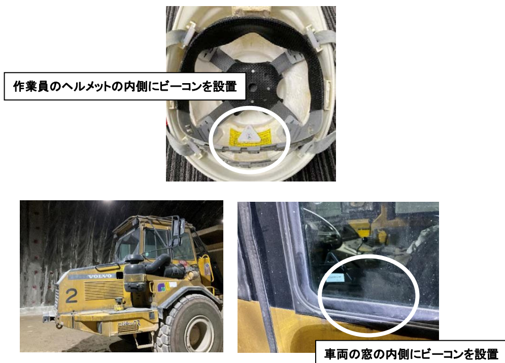
図-3.2 作業員ならびに工事車両の位置管理
