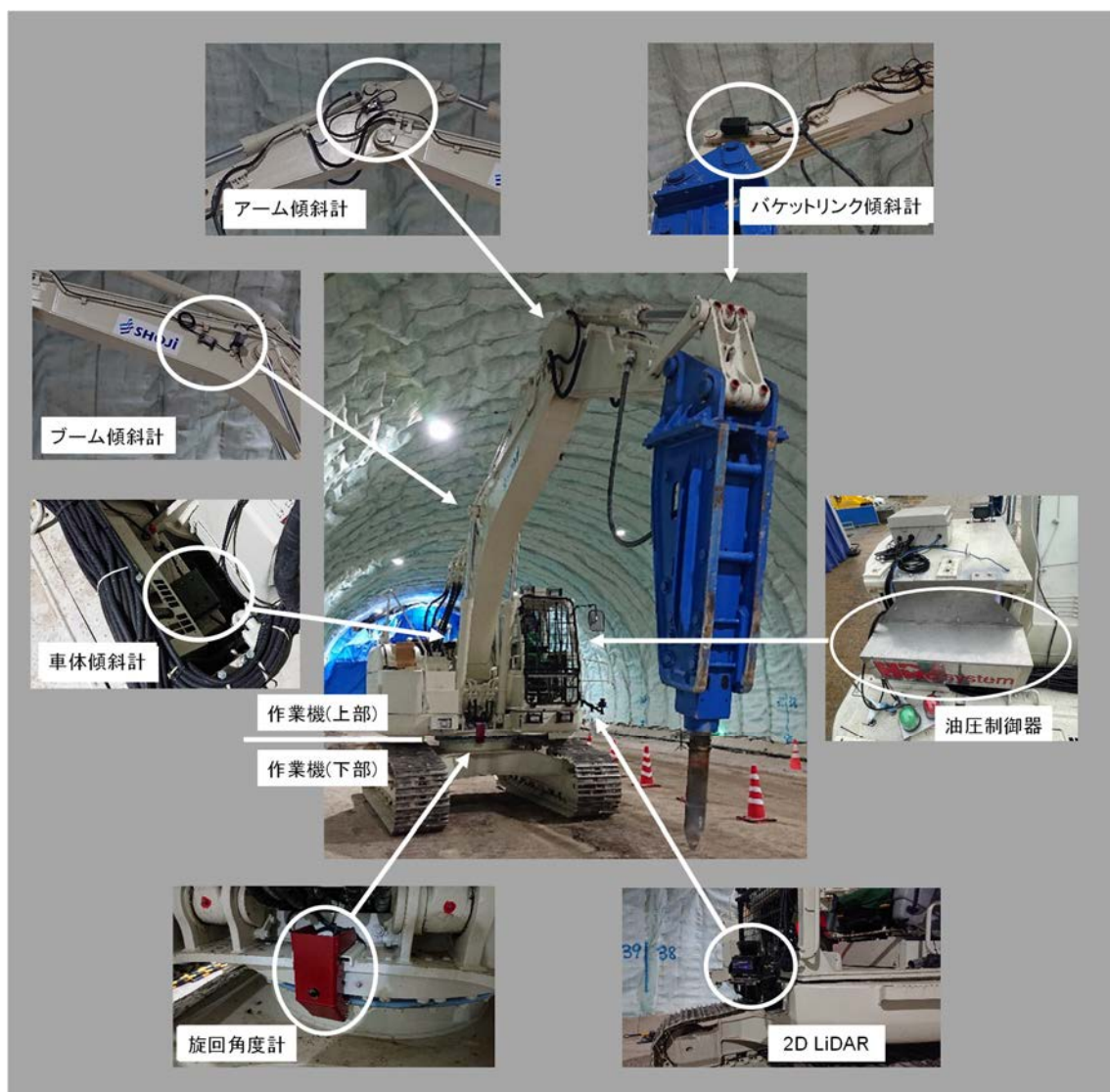
図-3.15 自動施工用バックホウ（ブレーカユニット装着）
