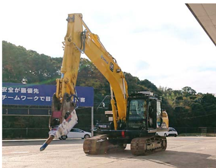
写真-4.1 標準アームの無人化施工対応バックホウ（ブレイカ装着）（住友建機 SH200）
