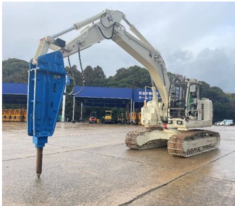
写真-4.7 山岳トンネル仕様の無人化施工対応バックホウ(大型ブレーカ) (コマツ PC228US)
