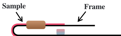
図 4-18. フレームの U 字部分に試料を沿わせたモデル (U-shaped sample model).
