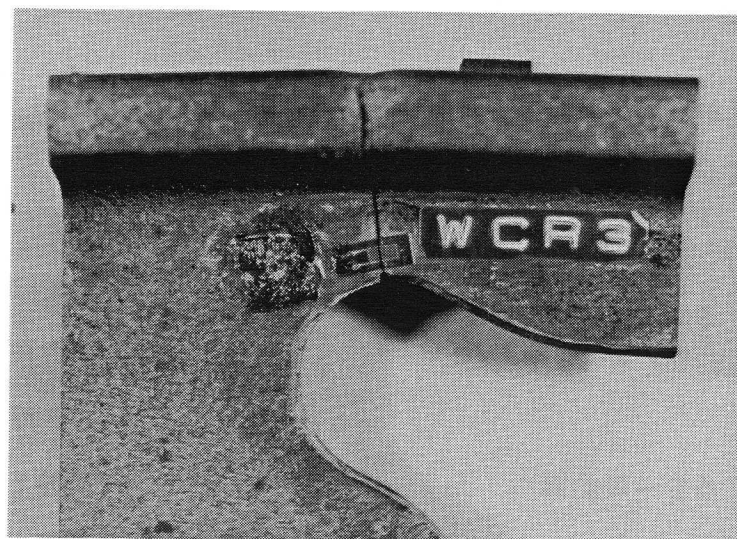
写真-5 Wタイプの配力鉄筋定着部の疲労亀裂進展状況。
