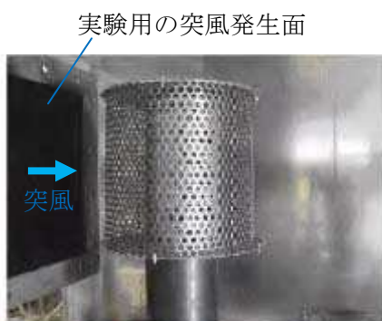
図 6-3 二重網付き円筒による外気取り入れ口(参考文献 6.6,6.7 より)
