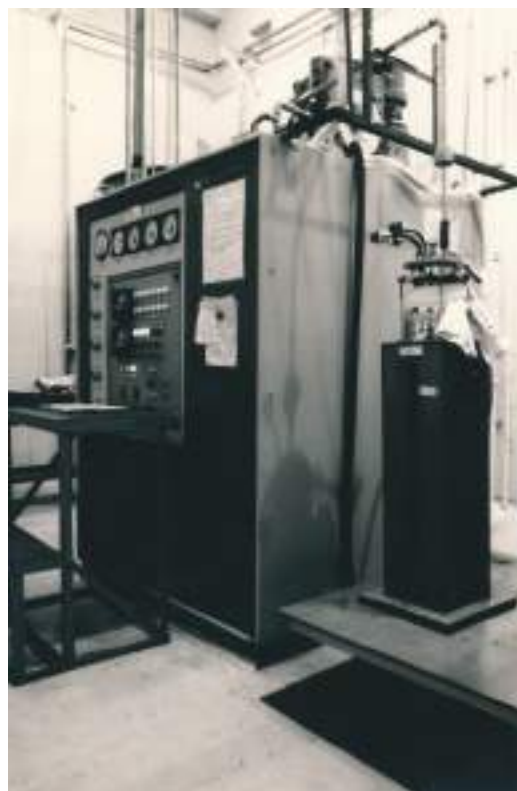
三菱製UL-80ヘリウム液化装置。低温センター初期に活躍。
