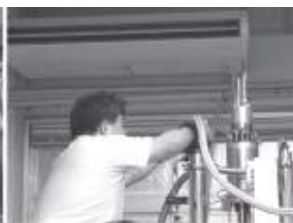
液体ヘリウムをデューワーからNMRに充填していく
