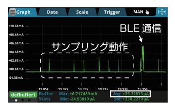
図9 計測器を用いて通信時の電流を計測した結果. ランダムアンダーサンプリングによる疎らなサンプリング動作後に, BLE の通信に係る電力消費が確認できる. 本フレームの平均消費電流は  $25.3\mu A$  である.
