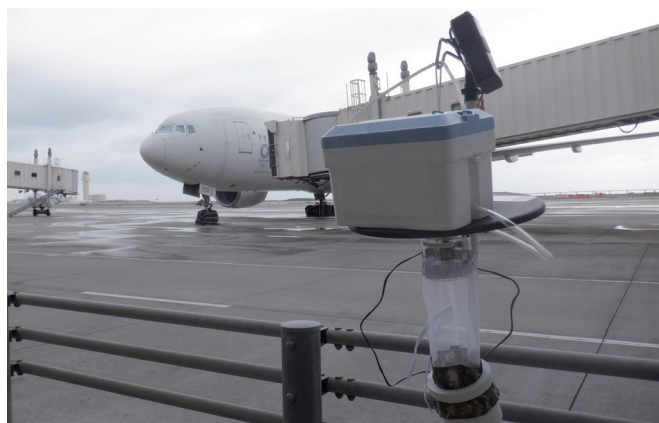
写真2 空港に仕掛けた蚊を捕獲するトラップ 上の箱にドライアイスがあり、二酸化炭素で蚊を誘引します。(検疫所で撮影)
