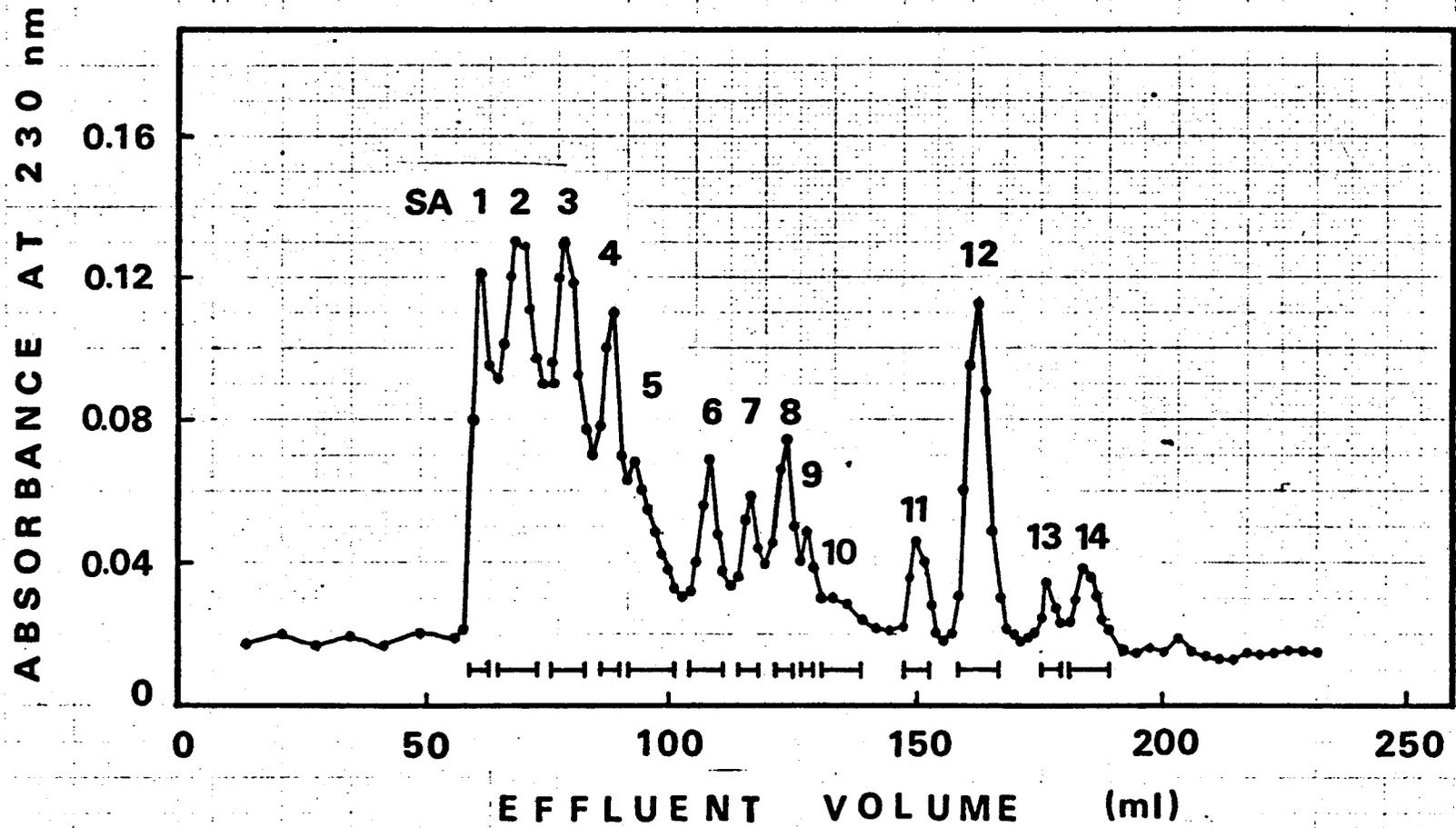
Fig. 6.  $(D'-S)_2$ -fragment (Fig. 4のPS-1)の硫酸分解物のBio-Gel P-2に於ける分離
