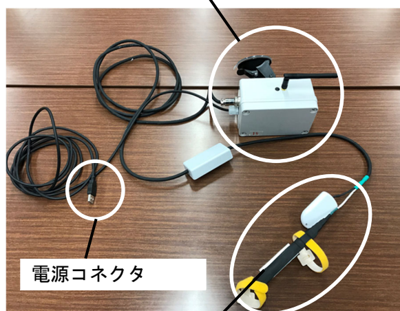
ダンプアップ検知部（触圧センサ，加速度センサ）
