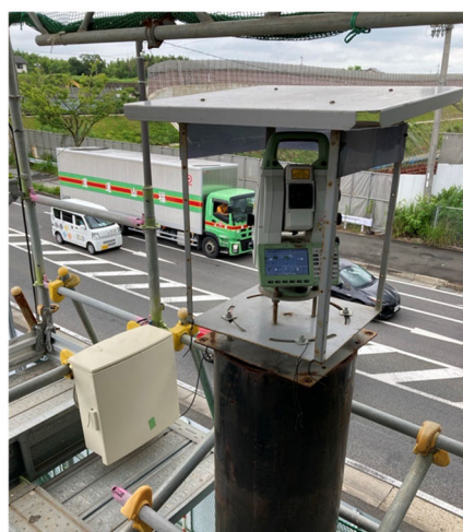
(a) 道路地盤の変位計測（自動）
