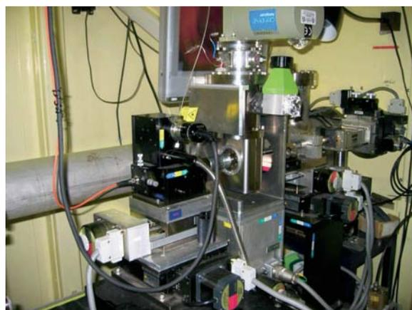
図3 低温・高圧粉末X線回折装置@KEK-PF:BL-18C
