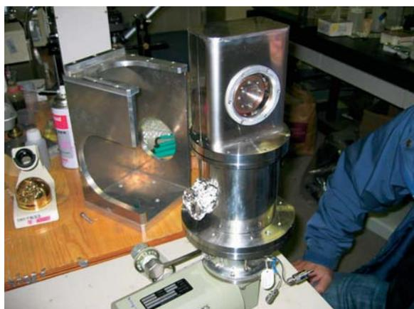
図2 ガス駆動型低温・高圧実験用セル
