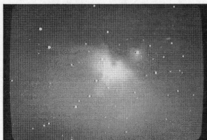
図2 画面全体が白い斑点で覆われるCCDの湧き出しノイズ。ダーク状態のもと60秒間露出を行なった。温度は290K。
