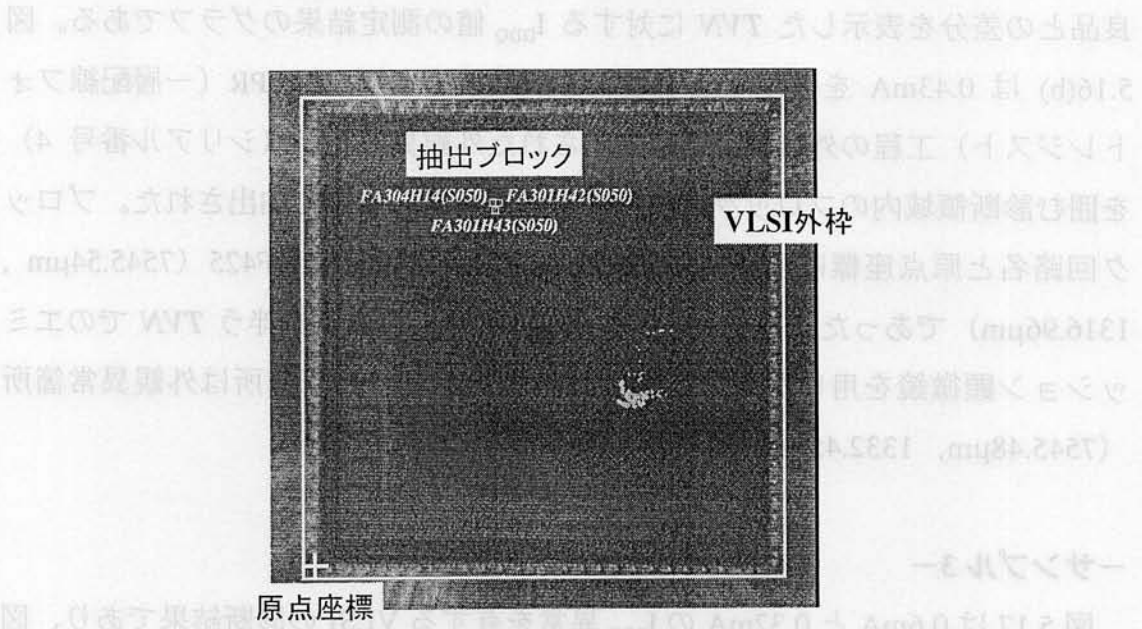
図 5.15 発光像と診断結果との重ね合わせ像
