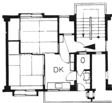
図2-4 51C型平面図
