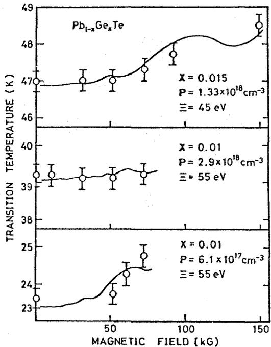
図2. 転移温度の磁場依存性。光学フォノンと電子の相互作用因子 $\Delta$ をパラメーターにとった。凝縮スピン分裂とランダウ分裂の大きさを等しくとってある。フェルミ分布の温度によるボクは計算に入れていない。
