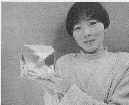
図2. 大型 \text{CsLiB}_6\text{O}_{10} 結晶。サイズ 14 \times 11 \times 11 センチ。育成期間3週間。
