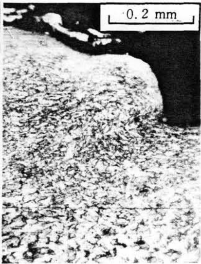
図2-3-42 窒素中での試験片断面の顕微鏡写真
