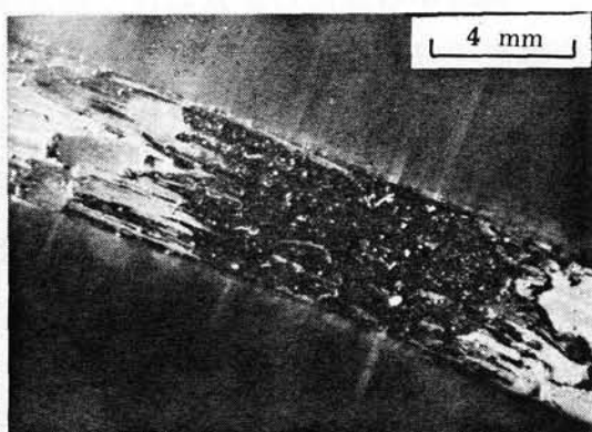
図2-3-21 試験片摩擦面上に残 ったはく片状摩耗粉
