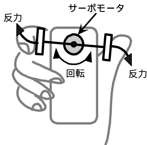
図 5.13 触覚フィードバックの原理
