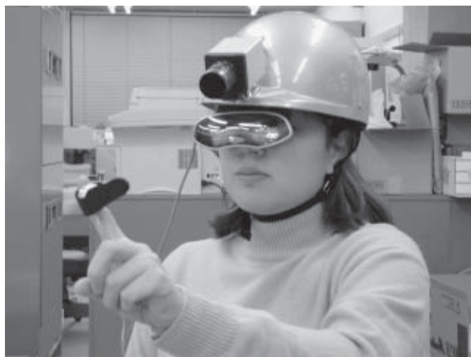
図 6.5 頭部装着部 (HMD と 3 次元座標入力装置)
