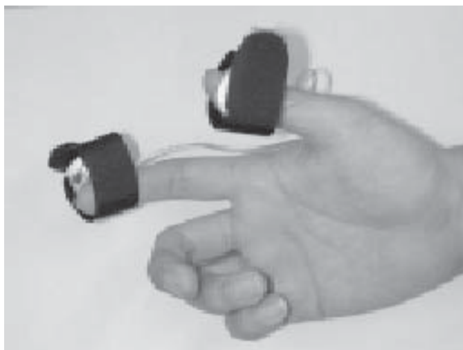
図 6.2 コイン型モーターを装着した様子
