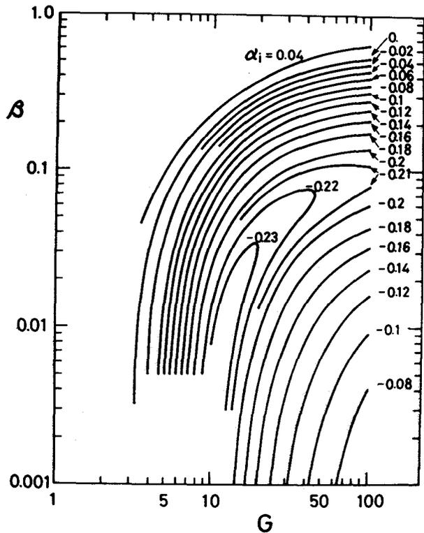
図 2.3  $\beta$ -G面の一定増幅率曲線 (Pr=0.7)
