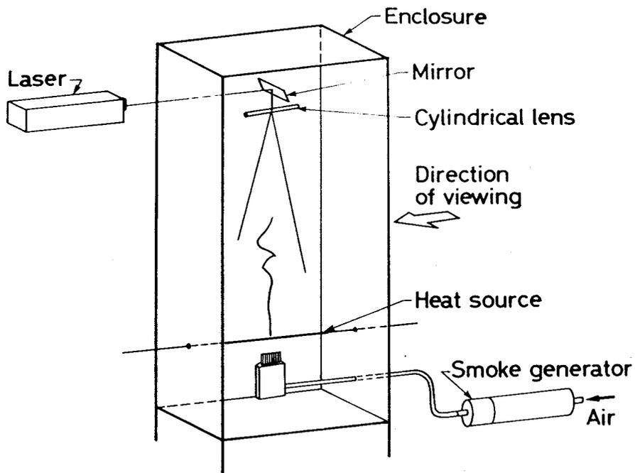
図 5.1 流れの可視化の概略図 (煙注入法)
