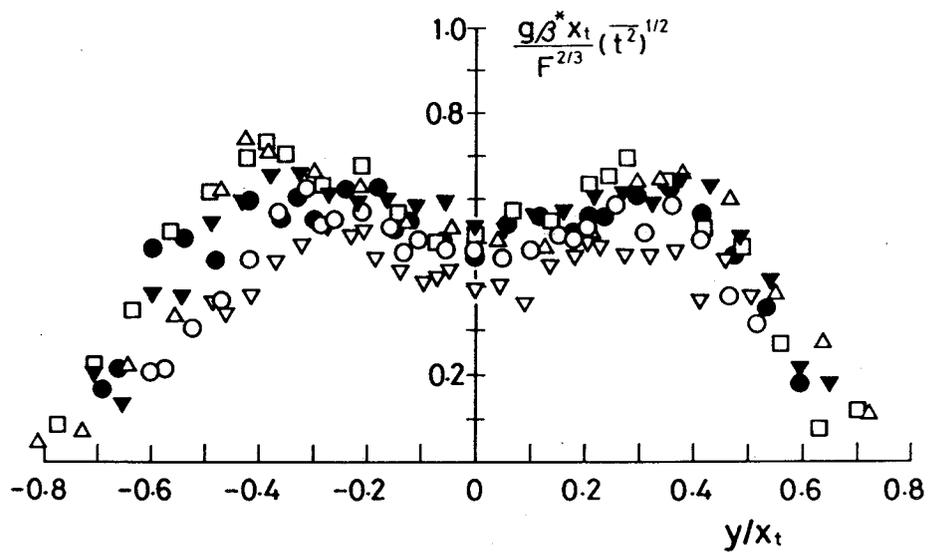
図 5.23 温度変動強さの分布 (自然遷移)  $Q = 20.5 \text{ W/m}$
