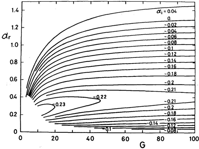
図 2.2  $\alpha_r$ -G面の一定増幅率曲線 (Pr=0.7)
