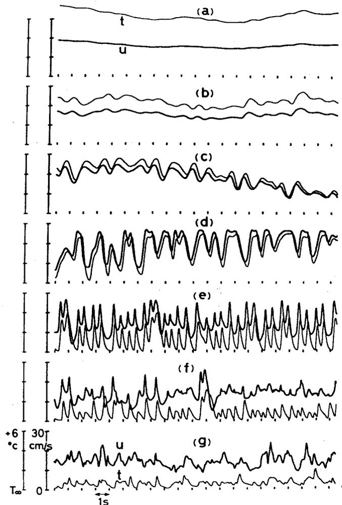
図 5.10 垂直速度および温度変動波形 (自然遷移)  $Q = 20.5$  W/m
