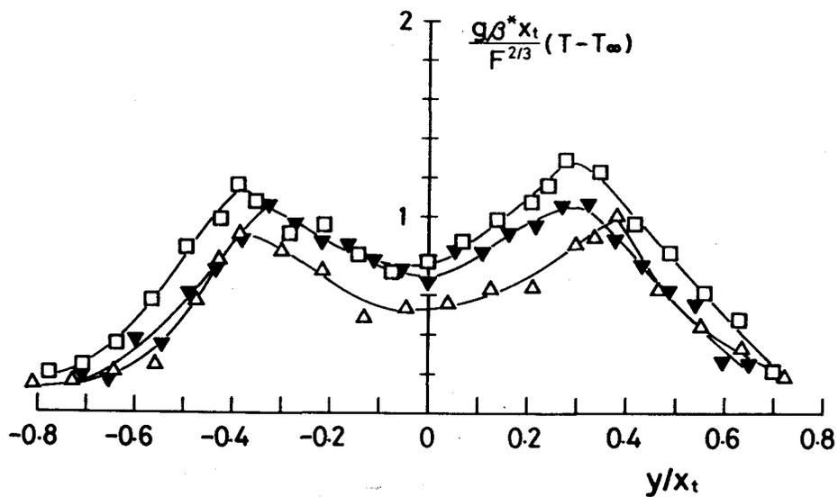
圖 5.20 時間平均温度分布 (自然遷移)  $Q = 20.5 \text{ W/m}$
