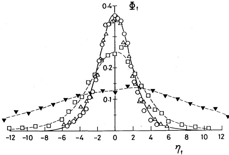
図 5.16 時間平均温度分布 (自然遷移), 実線は層流の理論数値解<sup>17)</sup>
