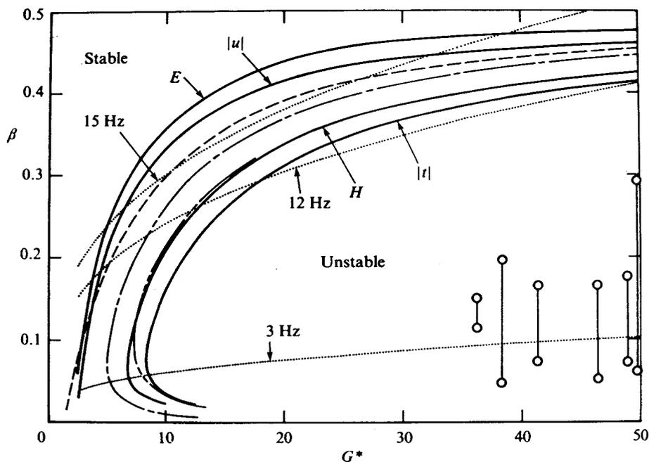
図 4.1 振幅と積分パラメータに基づく中立曲線 ( $Pr=0.7$ )
