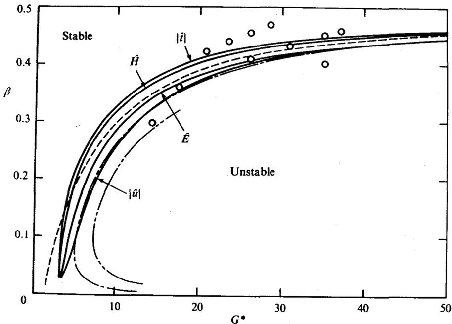
図 4.2 基礎流に相対的な振幅と積分パラメータに基づく中立曲線 ( $Pr=0.7$ )
