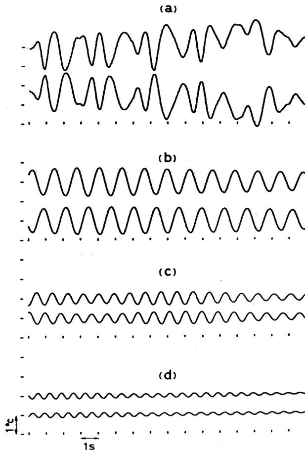
図 5.12 温度攪乱波形  $Q = 20.4 \text{ W/m}$ ,  $x' = 20 \text{ cm}$ ,  $y = \pm 5 \text{ mm}$  ( $G = 147$ )
