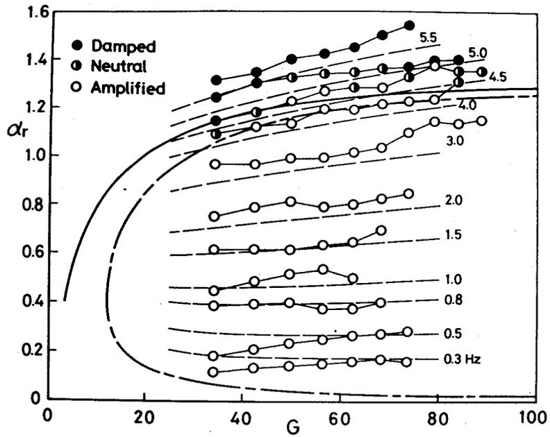
図 3.8  $\alpha_r - G$ 面上の実験データ ( $Q=10.7 \text{ W/m}$ )
