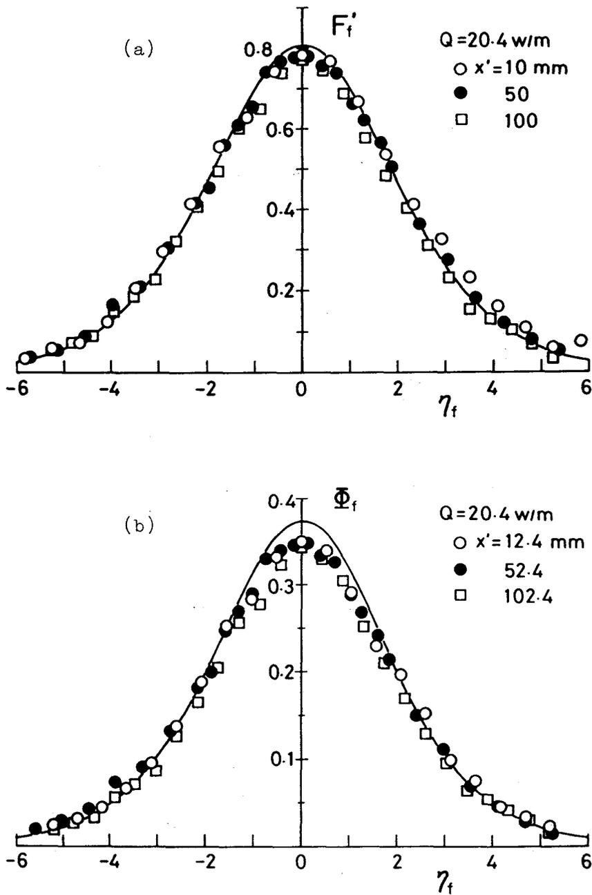
図 3.5 定常分布の測定結果 (a)速度の x 成分 (b)温度
