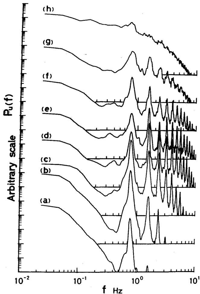
図 5.13 垂直速度変動のパワースペクトル (人工遷移)  $Q=20.5 \text{ W/m}$ ,  $f=0.8 \text{ Hz}$
