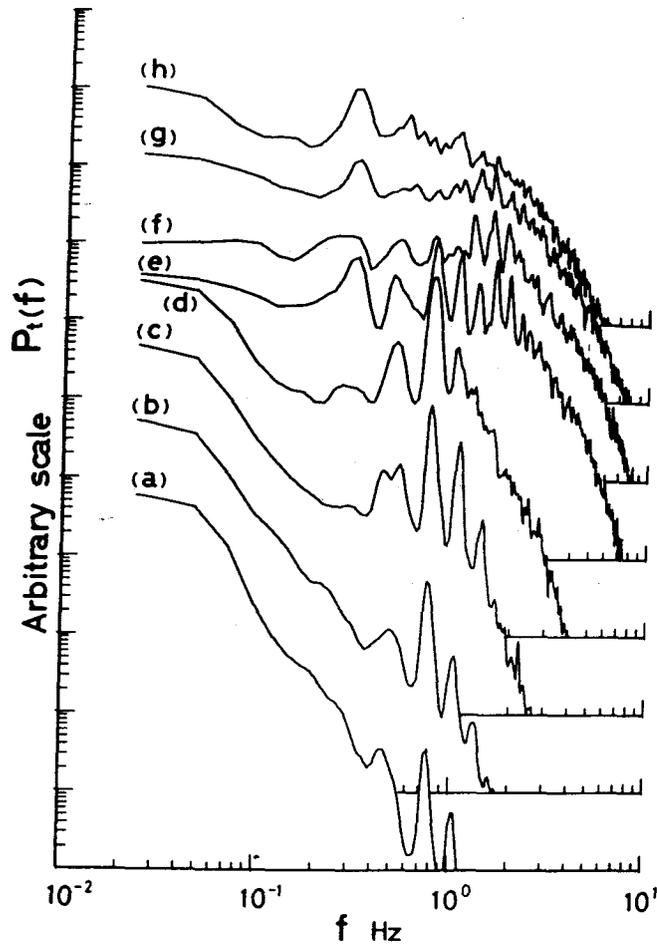
図 5.9 温度変動のパワースペクトル (自然遷移)  $Q = 20.5$  W/m
