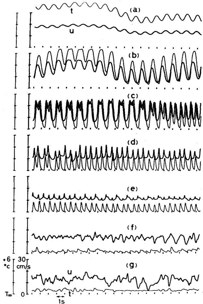
図 5.15 垂直速度および温度変動波形（人工遷移） $Q = 20.5 \text{ W/m}$ ,  $f = 0.8 \text{ Hz}$
