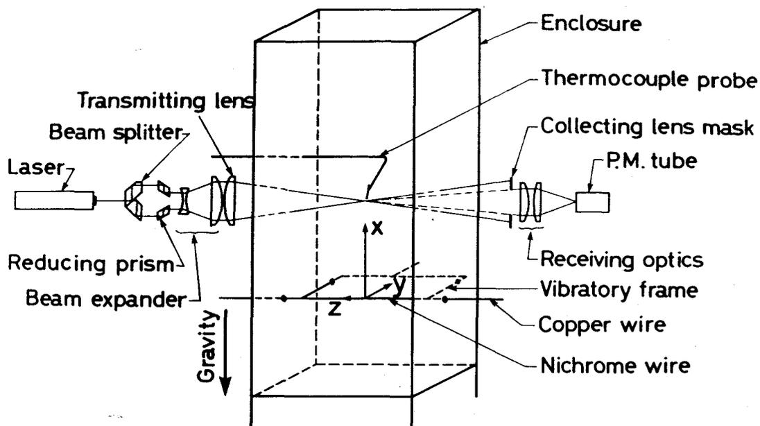
図 3.1 実験装置の概略図
