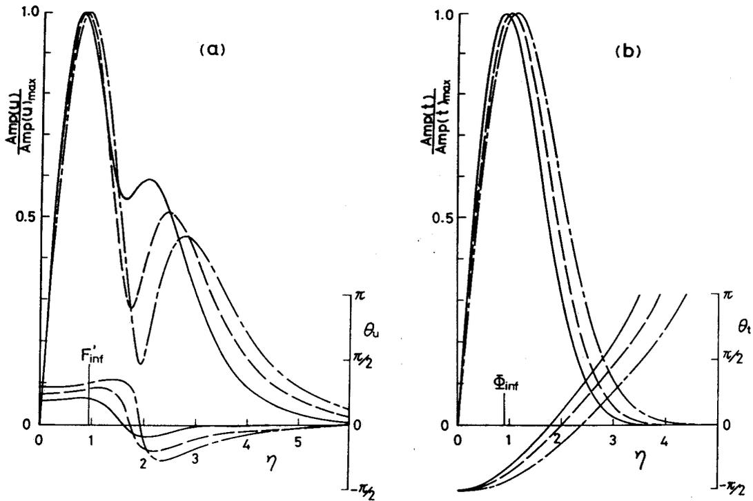
図 2.6 攪乱の振幅と位相の分布 (a) 攪乱速度  $u$ , (b) 攪乱温度  $t$
