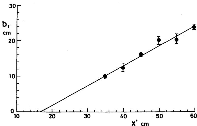
図 5.19 半値半幅の測定結果 (自然遷移)  $Q = 20.5 \text{ W/m}$
