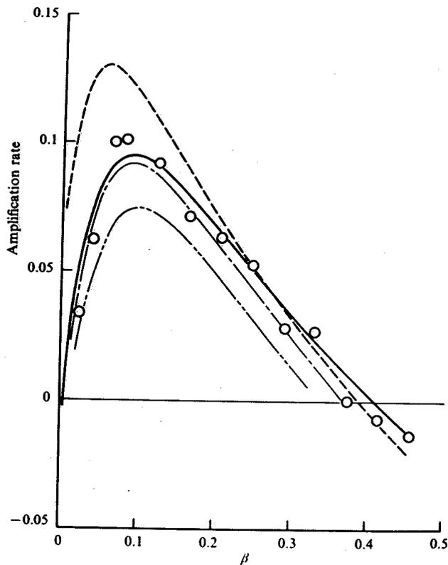
図 4.5 理論増幅率曲線 ( $G^* = 20$ ,  $Pr = 0.7$ ) と実験データの比較
