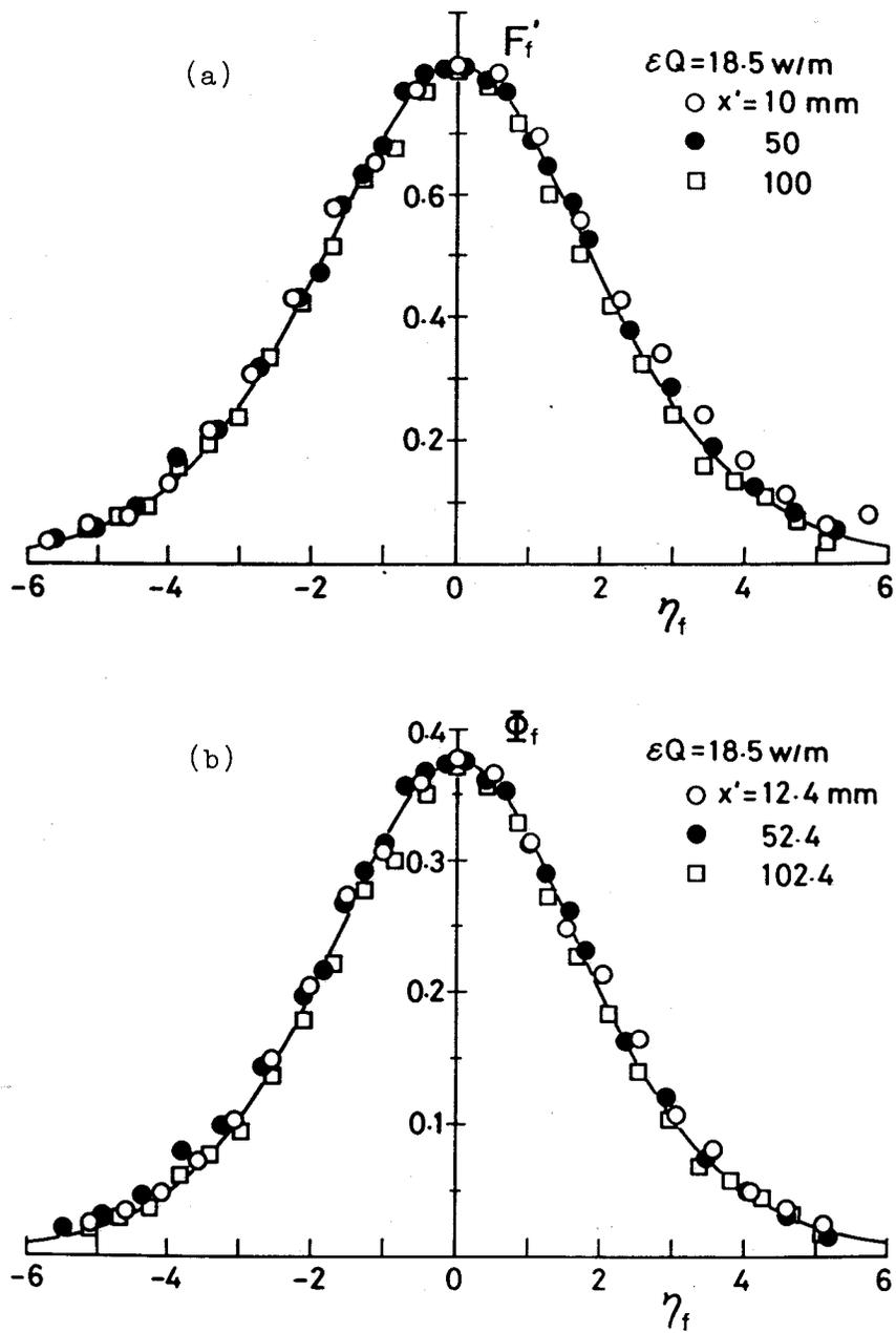
図 3.6 補正後の定常分布の測定結果 (a)速度の x 成分 (b)温度
