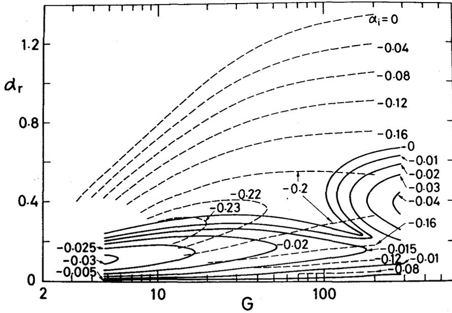
図 2.7  $\alpha_r$ -G面の一定増幅率曲線 ( $Pr=0.7$ )
