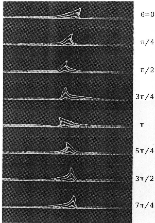
図 5.28 タイムラインの可視化写真 (人工遷移)  $Q = 20.6 \text{ W/m}$ ,  $x' = 20 \text{ cm}$ ,
