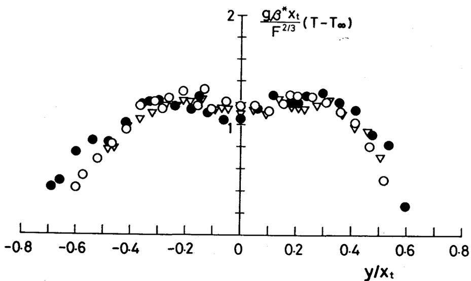
圖 5.21 時間平均温度分布 (自然遷移)  $Q = 20.5 \text{ W/m}$
