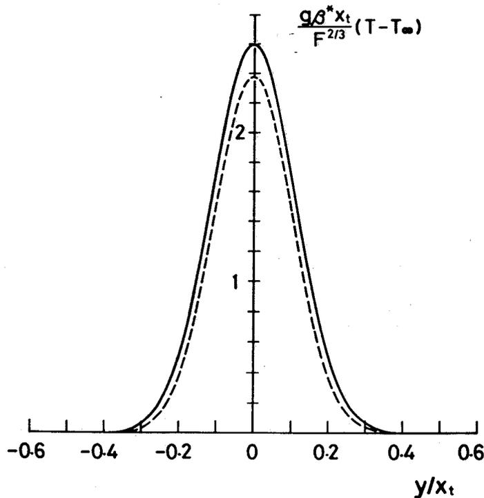
図 5.18 他の研究者による時間平均温度分布の測定結果
