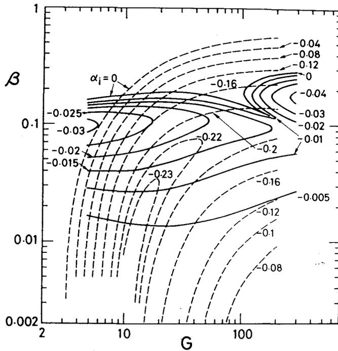
図 2.8  $\beta$ -G面の一定増幅率曲線 ( $Pr=0.7$ )
