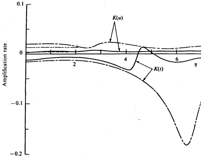
図 4.6 振幅についての増幅率の  $\eta$  分布 ( $Pr=0.7$ )
