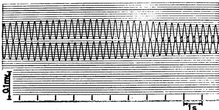
図 3.7 温度攪乱波の反対称性  $f = 3.0$  Hz
