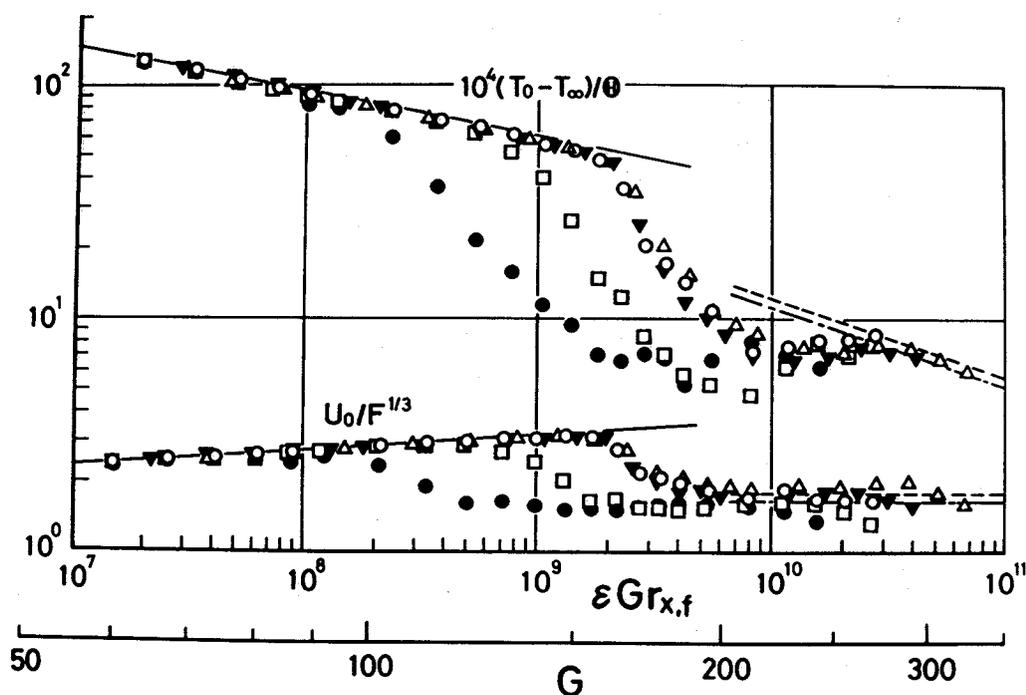
図 5.3 プルーム中心面の時間平均垂直速度成分と温度
