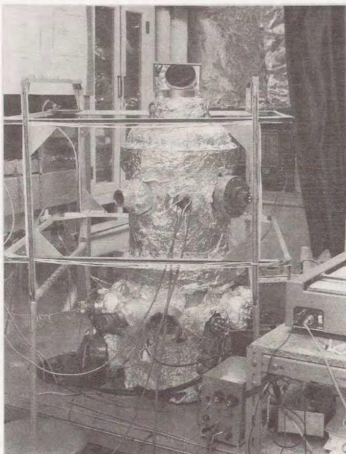
図 4-1 REELS 測定装置の外観写真。
