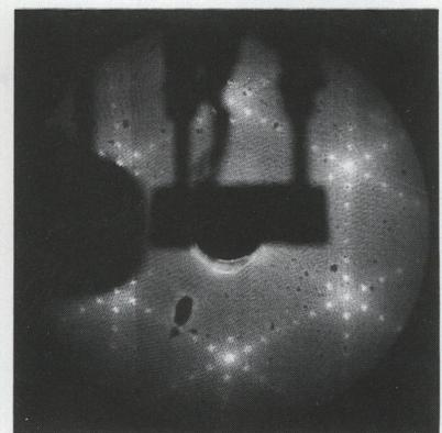
図5.4 基板温度400 °Cで水素を吸着させたときのLEED像
