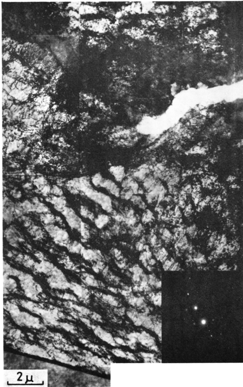
図 2.20 ステンレス鋼の疲れき裂先端部に形成された転位組織
