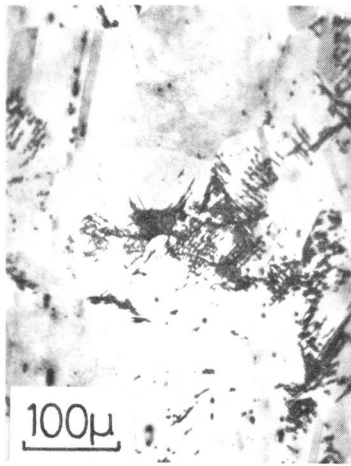
(a) N = 3.3 \times 10^9 \sim 9 \times 10^9 サイクルの間に発生した 微小き裂
