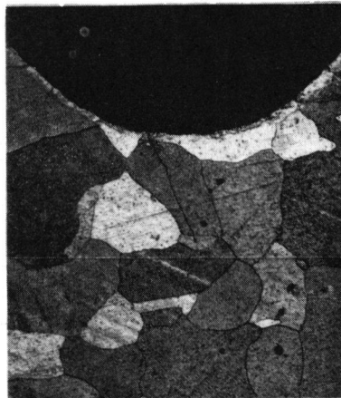
図 5.4 耐久限度よりわずかに低い応力を 10^7 回繰返した後の切欠き底の縦割り断面
