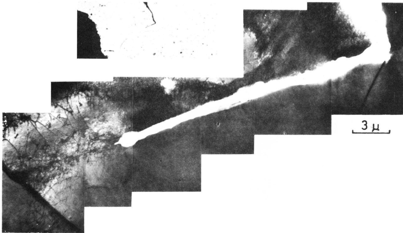
図 2.16 結晶粒界で著しく進展方向を変えられた き裂の先端近傍組織(鉄)
