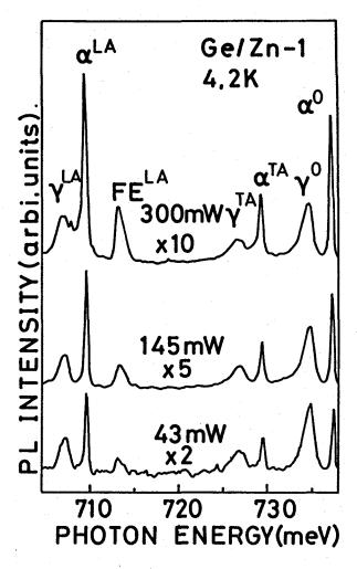
図1 ZnをドープしたGe のフォトルミネッセンスの 励起強度依存性
