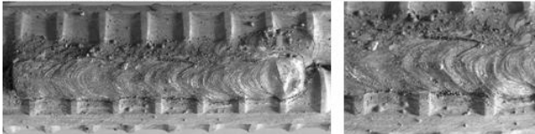
(d)Welding rod : D4340 Galvanized rebar size : D19
