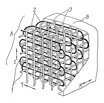
図1 三次元織物強化有機複合材料の概念図
