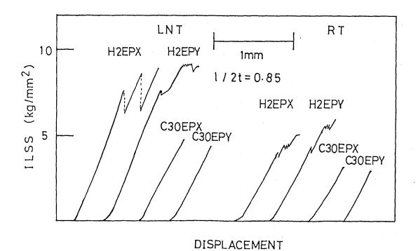
図 2(b) 室温(RT)と液体窒素温度(LNT)における三次元FRP(H2EP)と 二次元FRP(C30EP)の剪断強度一変位線図
