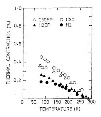
図3 三次元FRPと二次元FRPの熱収縮
