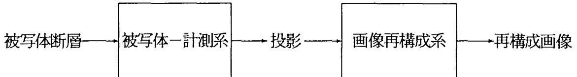
図9: X線CT装置（断層撮影モデル）は、被写体－計測系と画像再構成系から構成される。
