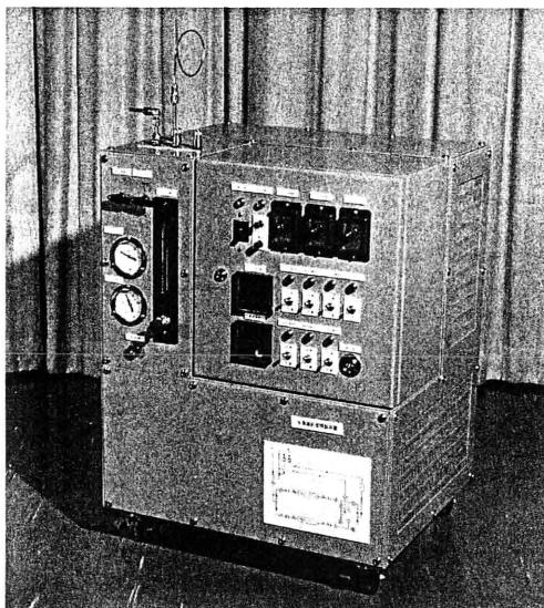
図8.27 \text{TiMn}_{1.5} 水素化物を用いた高純度水素精製装置の外観
