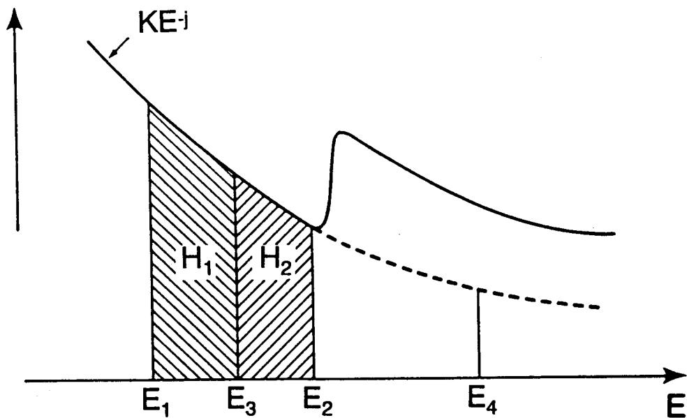
図6-8 バックグラウンドの引算方法
