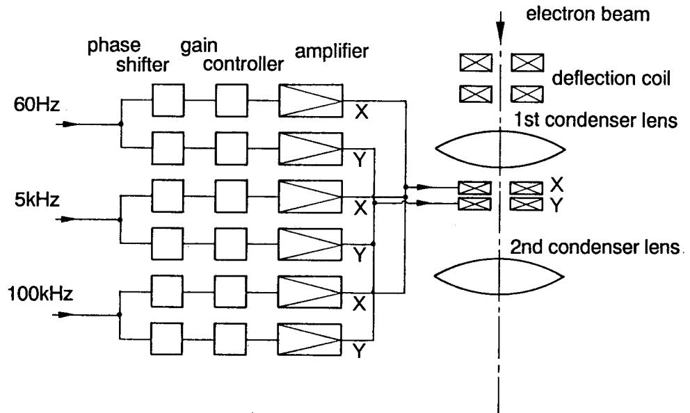
図 3-5 淫れ磁束による偏向の補償回路ブロック図
