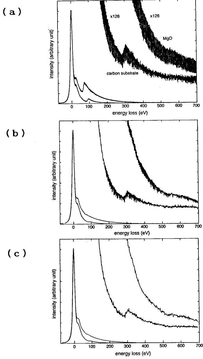
図 6 - 7 チャンネル間のばらつき補正例
