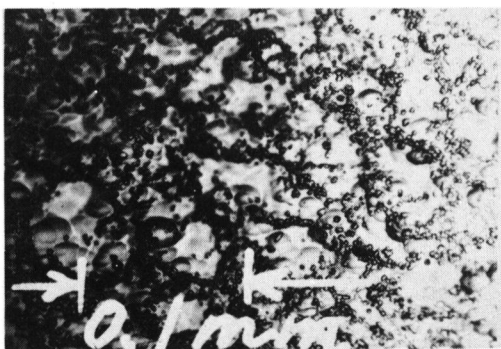
写真1.7 BBP' 試料のエッチ・ピット ベンド半径 5 cm 〔111〕面に垂直な面
