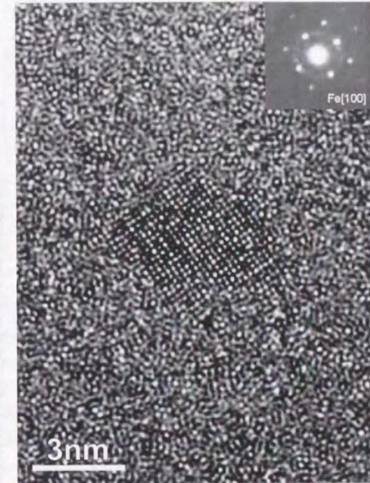
図4-19 a-Fe<sub>99</sub>Zr<sub>7</sub>B<sub>3</sub>Cu<sub>1</sub> 合金 693K 熱処理試料で観察された  $\alpha$ -Fe ナノ結晶の HREM 像と NBD パターン
