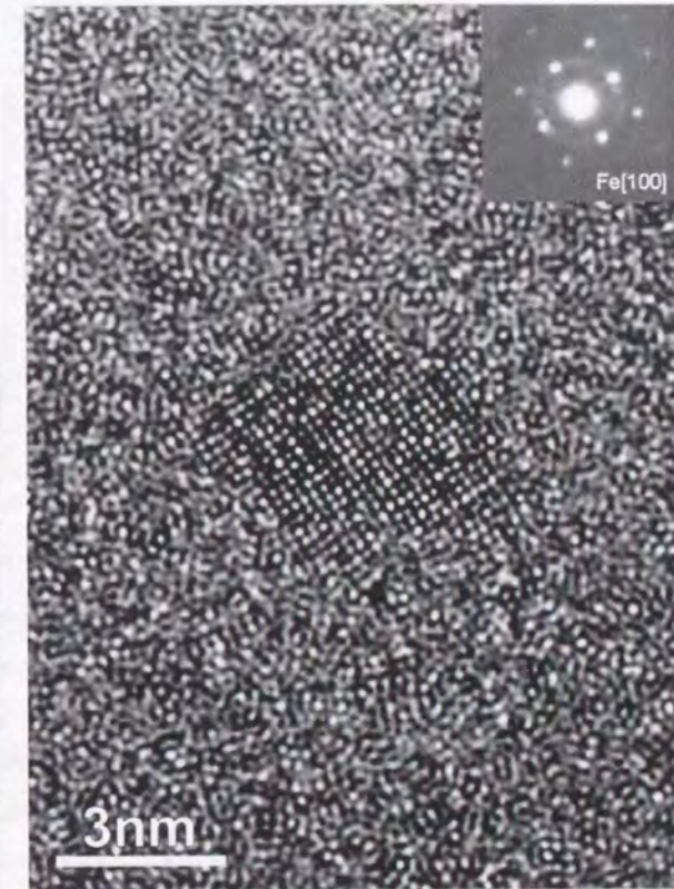
図4-19 a-Fe 99 Zr 7 B 3 Cu 1 合金 693K 熱処理試料で観察された \alpha -Fe ナノ結晶の HREM 像と NBD パターン
