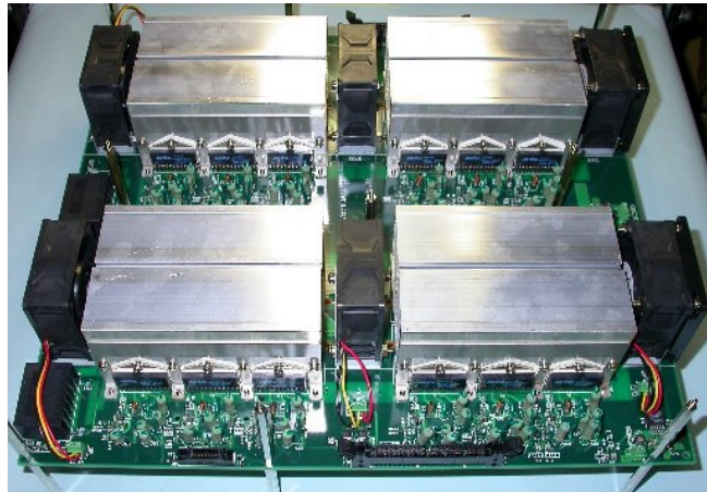
図 3.4-2 Driver ボードの外観
