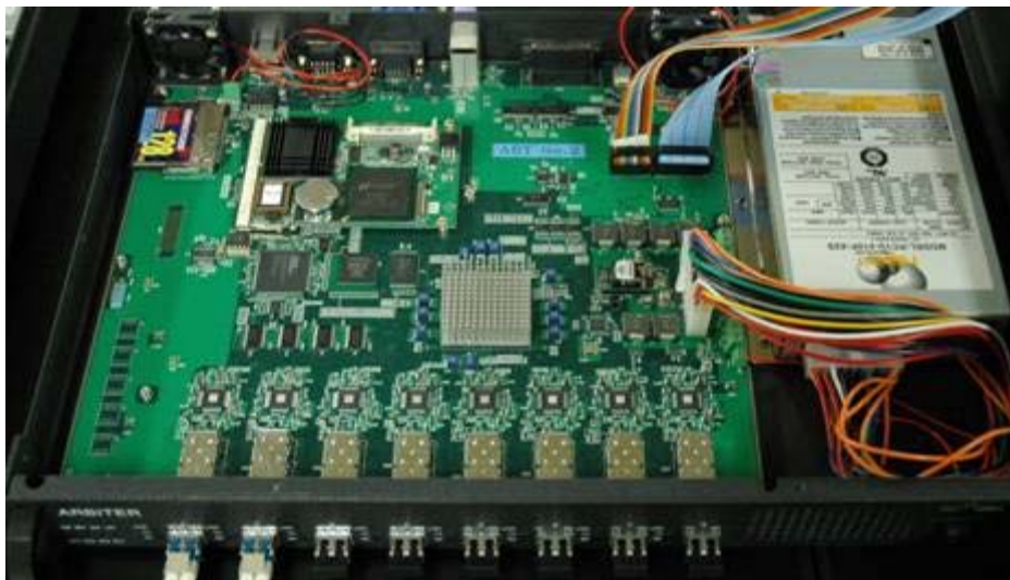
図 5.8-15 アービタ部内部構成
