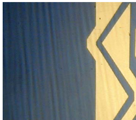
図 3.6-1 PLZT 偏向素子のストリエーション (右の明るい部分はプリズム電極)
