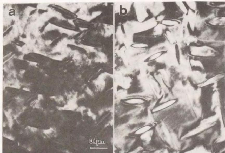
図10-7 773kで3.6ks時効した試料の明視野像 (a):Ti<sub>49</sub>Ni<sub>51</sub>
