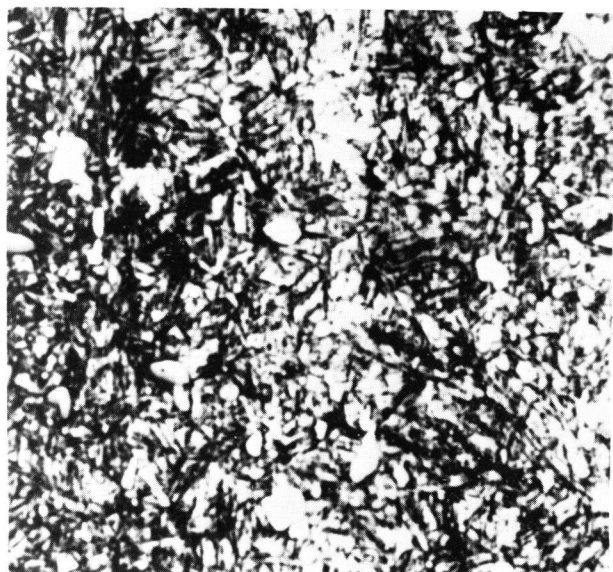
図2・2 高速度鋼 SKH4 の組織
