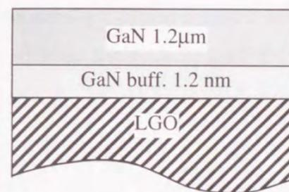
図5-9 LGO基板上Ga<sub>N</sub>成長のサンプル構造
