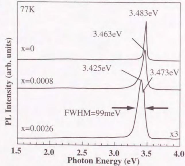
図4-26 AsH<sub>3</sub>供給量を0、0.1、0.3 SCCMと変化させたGaNA<sub>s</sub>混晶からのPLスペクトル
