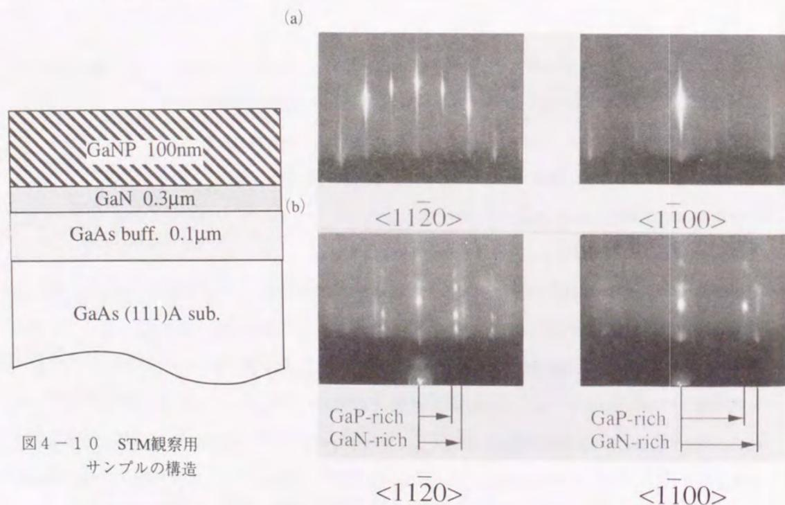
図4-10 STM観察用サンプルの構造
