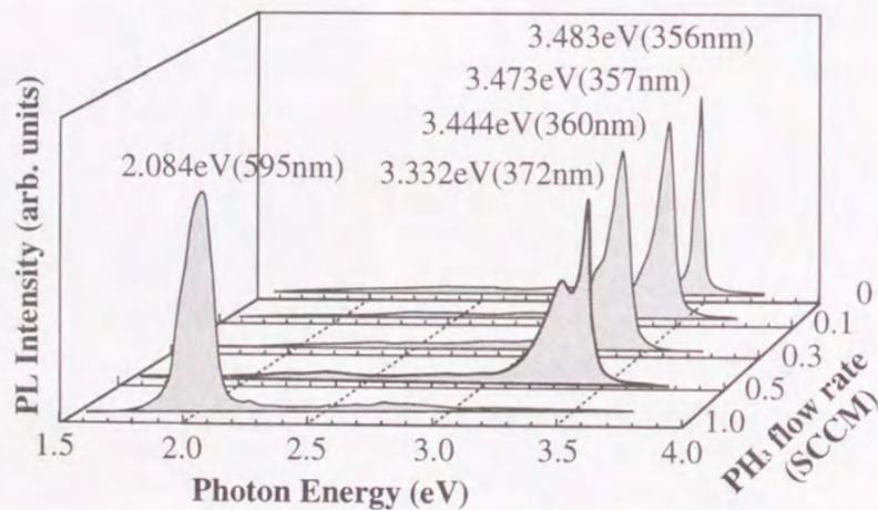
図4-15  $\text{PH}_3$ 供給量を0, 0.1, 0.3, 0.5, 1.0 SCCMと変化させてサファイア基板に結晶成長したGaNP混晶の、77KにおけるPLスペクトル
