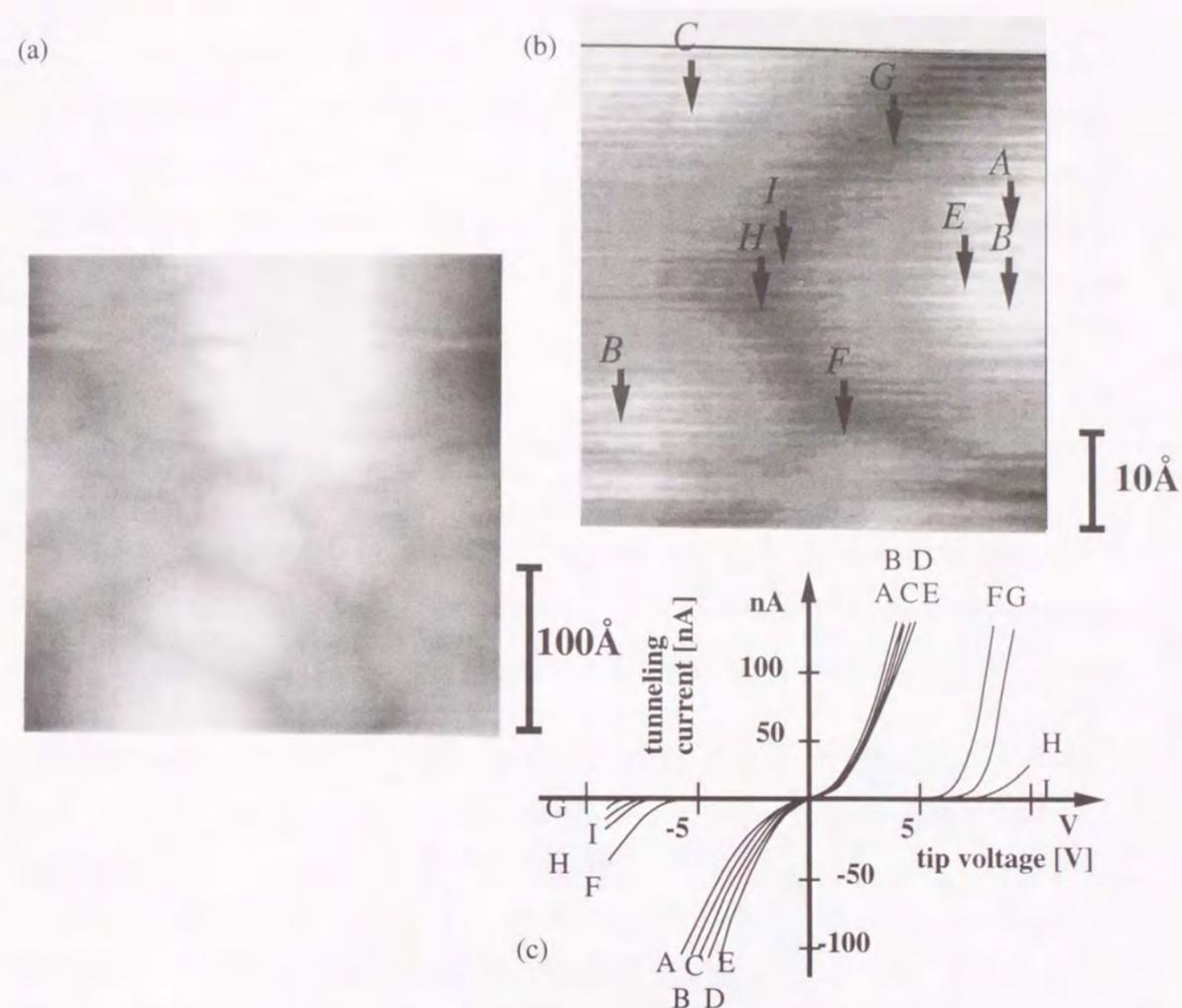
図4-14 GaNP混晶との相分離をSiドープGaAs(111)基板上に再現したサンプルのSTM/STS観察
