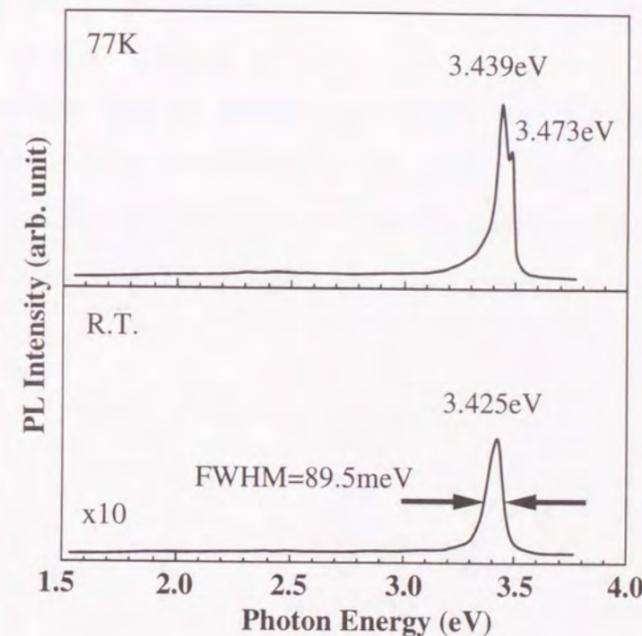
図5-10 LGO基板上Ga<sub>N</sub>からのPLスペクトル
