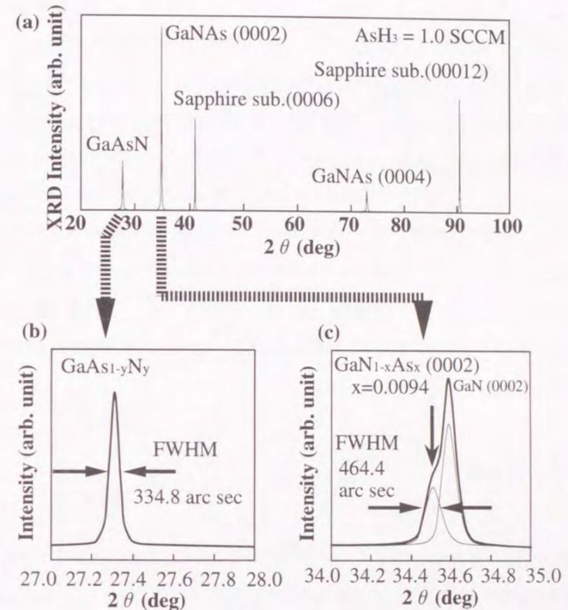
図4-24 Asの供給量が多いAsH<sub>3</sub>=1SCCM供給の条件で作製したGaNAs混晶からのX線回折測定
