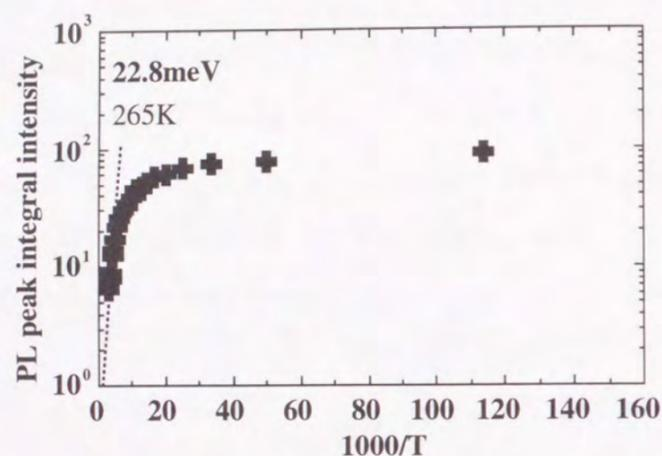
図6-12 石英ガラス基板上多結晶Ga<sub>N</sub>薄膜のPLピーク積分強度の温度依存性
