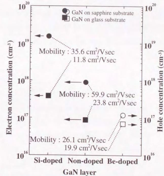
図6-19 石英ガラス基板上GaN、サファイア基板上GaNのそれぞれの場合における、ノンドーブ、Si不純物添加によるn形ドーブ、Be不純物添加によるp形ドーブのサンプルの、ホール効果測定によるキャリア濃度と移動度の測定結果
