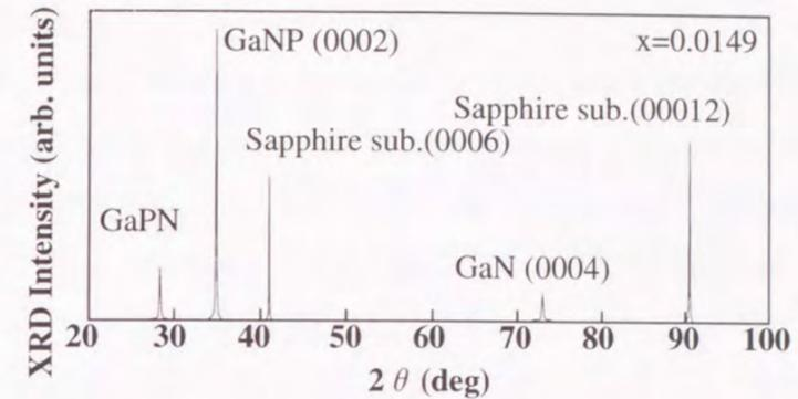
図4-9 Pの供給量が多いPH<sub>3</sub>供給量1SCCMの条件で作製したGaNP混晶からのX線回折スペクトル
