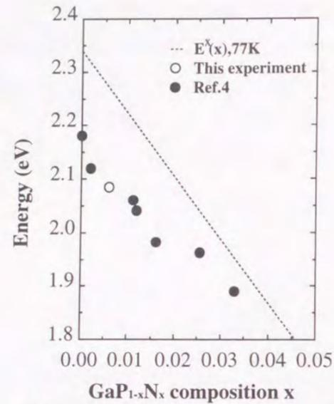
図4-17 GaPに添加するNの量を増加していった時のPLピークエネルギーをプロットしたBaillargeonらの実験結果に本研究のPH<sub>3</sub>供給量1.0 SCCMのGaNP混晶からのPLピークエネルギーを加えた図
