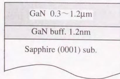
図3-3 GaN結晶成長実験用サンプル構造
