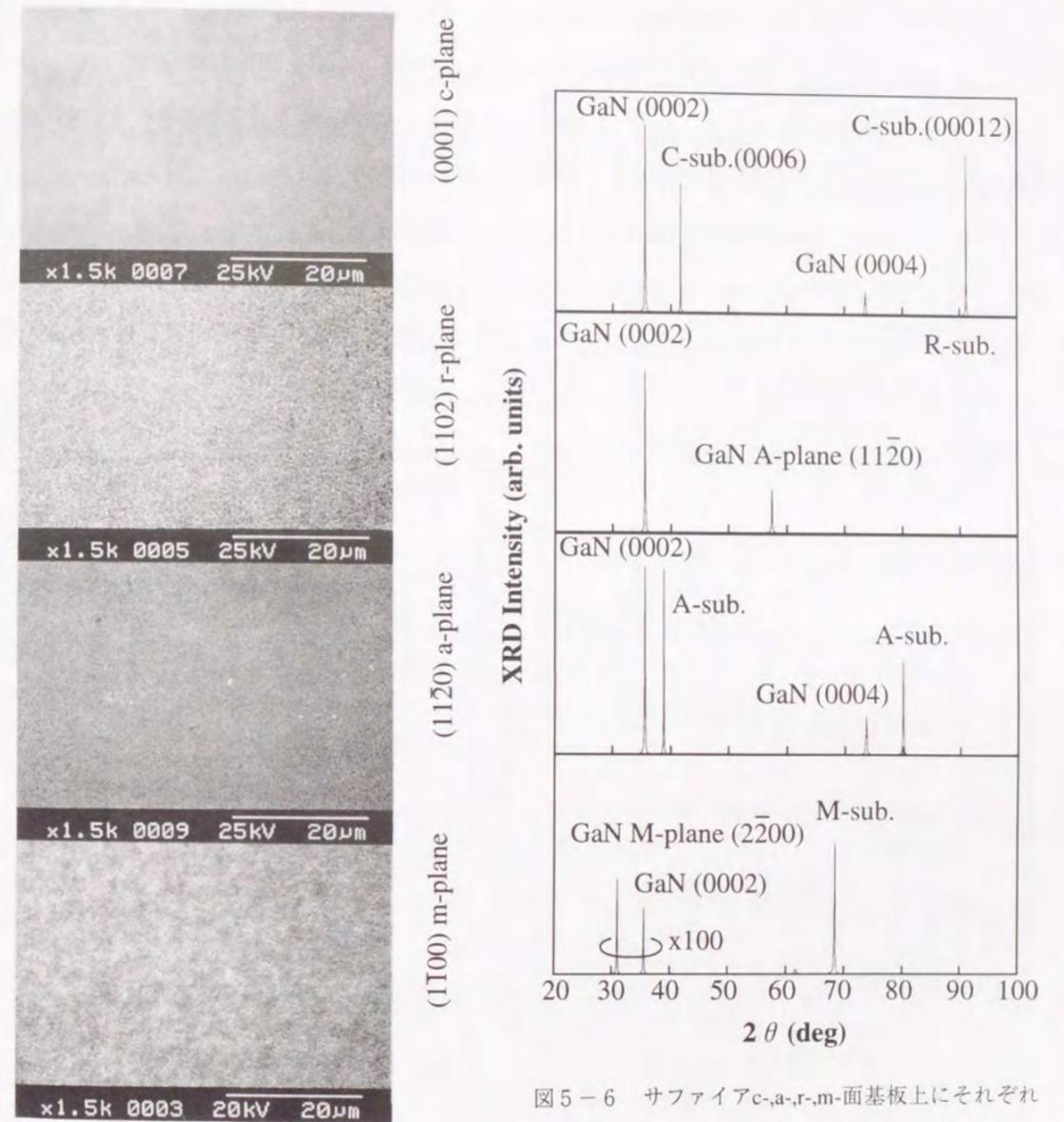
図5-6 サファイアc-,a-,r-,m-面基板上にそれぞれ成長したGaN薄膜のXRDロックアップカーブ
