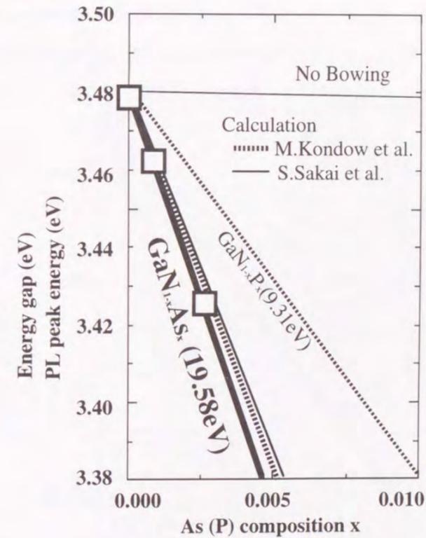
図4-27 実験値であるGaN<sub>1-x</sub>As<sub>x</sub>混晶組成比xとGaN<sub>1-x</sub>As<sub>x</sub>混晶のバンドギャップエネルギーの関係。
