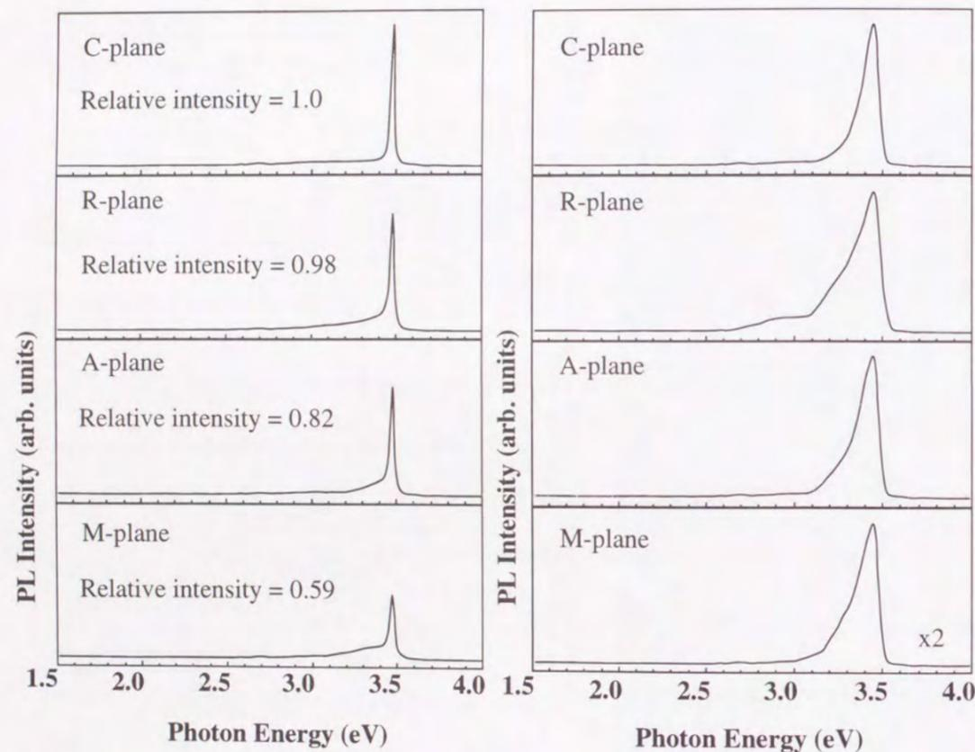
図5-7 77Kにおけるサファイアc-,a-,r-,m-面基板上に成長したGa<sub>N</sub>薄膜のPLスペクトル
