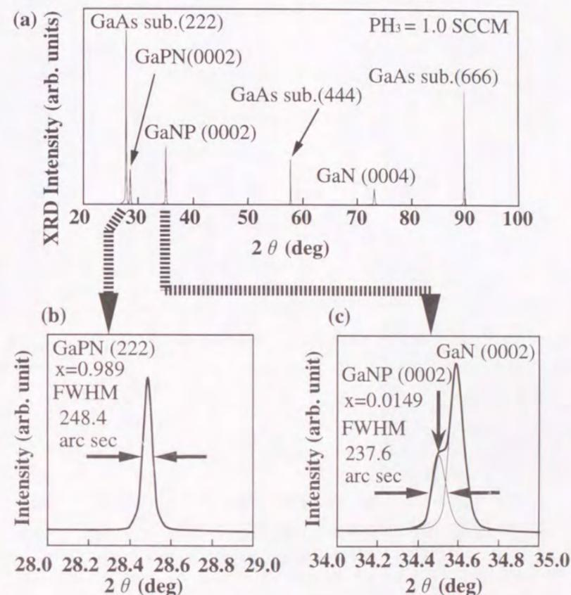
図4-12 STM観察用サンプルのX線回折測定
