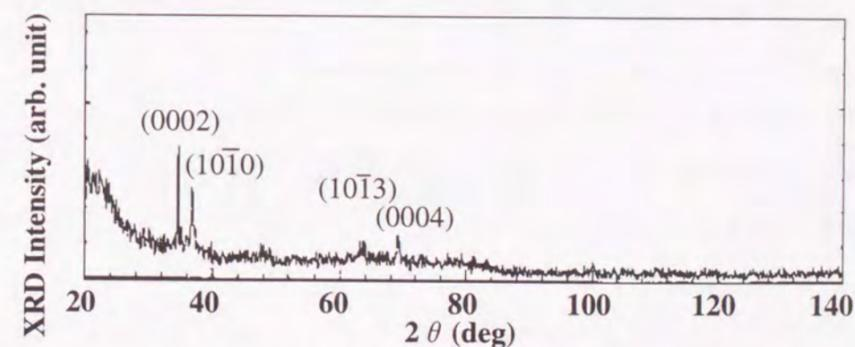
図6-2 石英ガラス基板上Ga<sub>2</sub>O<sub>3</sub>のX線回折の測定結果
