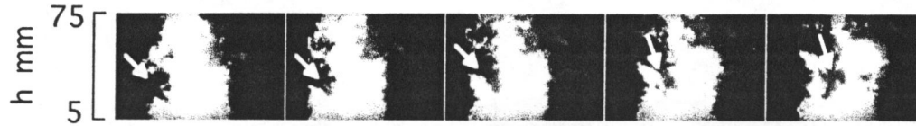
図 4-8 噴霧断面連続像の一例 (撮影領域 h=5\sim 75 mm)
