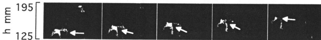
図 4-10 噴霧断面連続像の一例 (撮影領域  $h=125\sim 195$  mm)
