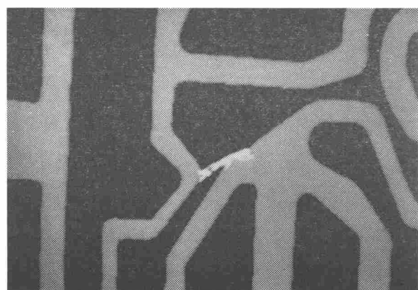
(d) 傷パターン 〔境界修正法の処理対象領域は図 3.11 のパターン〕
