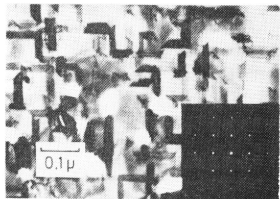
図3.12 積層欠陥を持つイオンプレーティング膜 (基板温度: 300℃)
