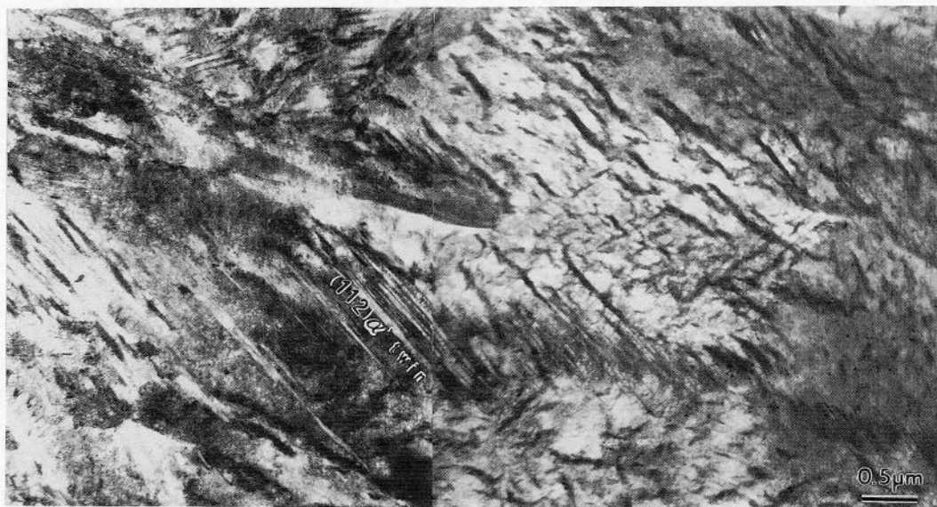
図7.11 1.10%炭素鋼のマルテンサイトの焼戻し組織(250°C, 3日). 非双晶領域では \theta -炭化物は多重バリエーション形態をとっている。
