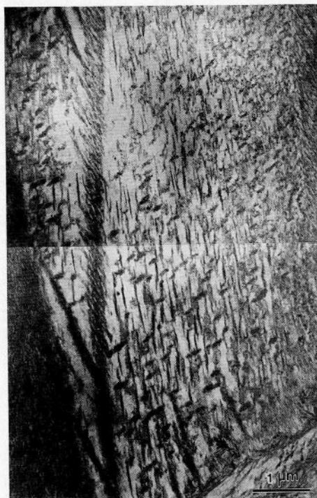
図4.13 1.87%炭素鋼の300°C, 1時間の焼戻し組織, セメントライトはミッドリブ領域では \{112\}_{\alpha} 双晶面に沿って一方向析出するが、ミッドリブ以外の領域では多重バリエーション形態をとる。
