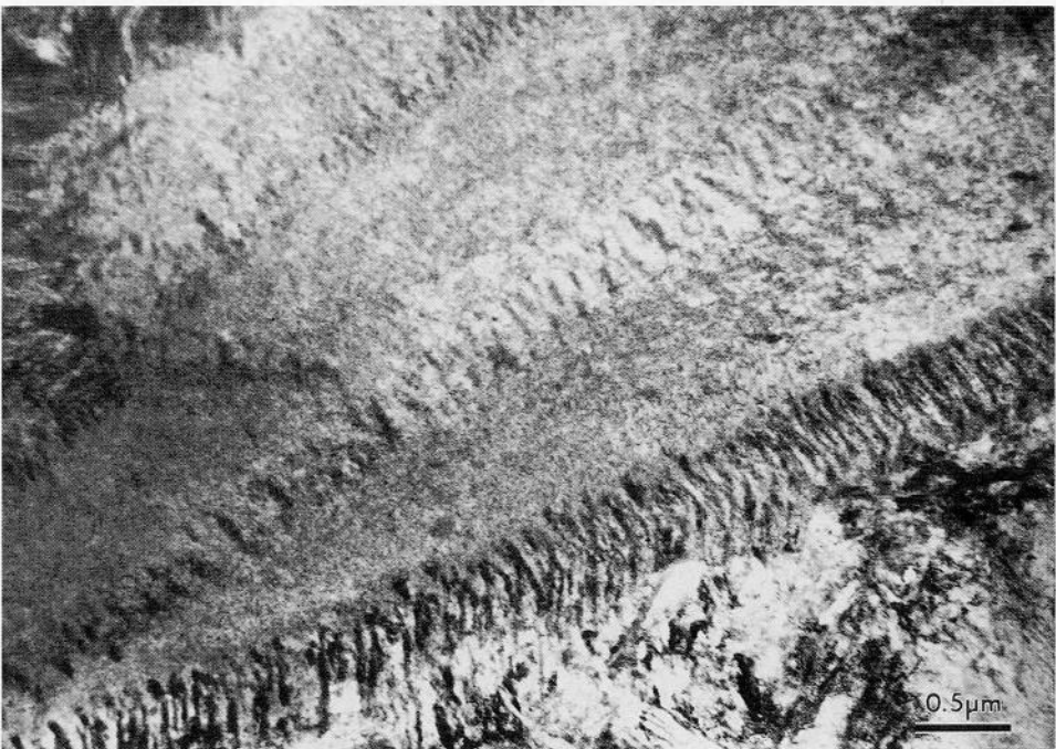
図9.5 1.80%炭素鋼の残留 \gamma の250°C, 1.5hの焼戻しによる分解生成物のTEM組織. \gamma/\alpha' 界面より成長した下部ベイナイトの周りを不定形生成物を取り囲んでいる.
