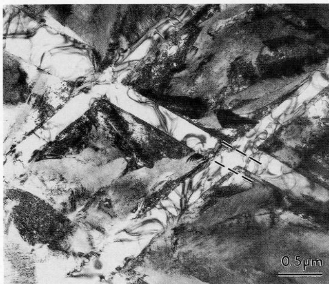
図5.9 初析 \theta 板の交叉。交叉部でずれを生じている。
