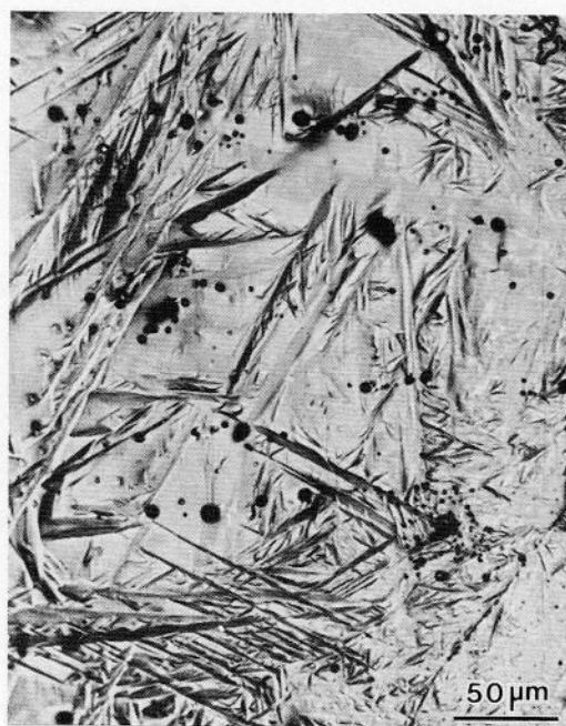
図3.4 1.87%炭素鋼のマルテンサイトの 表面起伏。ノマルスキー干渉。
