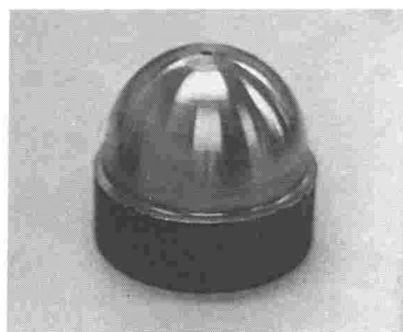
図 I. 3.10 間欠減速送り切削による 円弧切削の仕上写真
