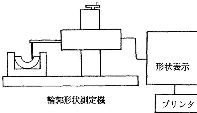
図 I. 4.8 真円度測定のための機器構成
