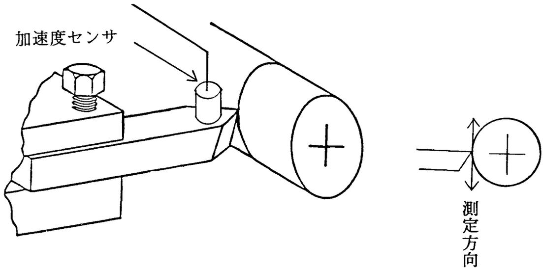
図 I. 3.12 加速度センサの取り付け位置
