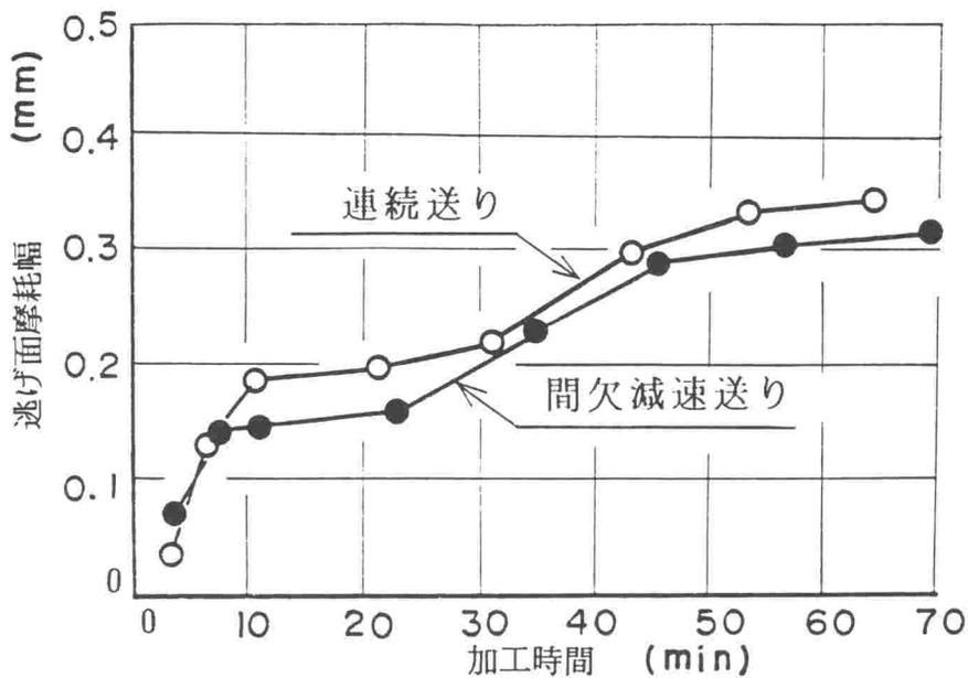
図 I. 3.4 加工時間と逃げ面摩耗幅
