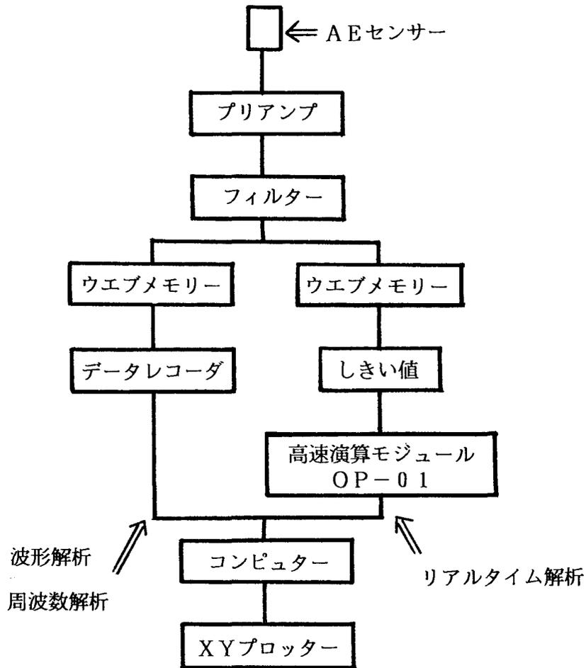
図Ⅱ. 4.1 AE信号の計測システム
