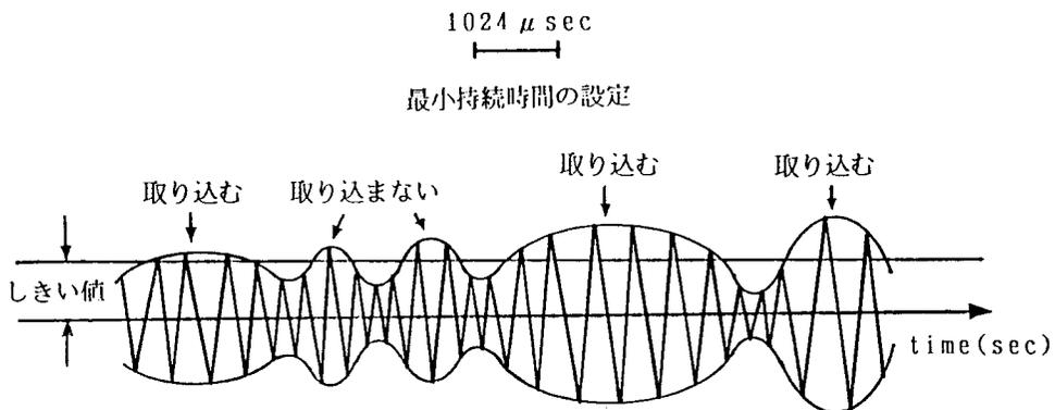
図II. 3.8 設定最小持続時間による弁別
