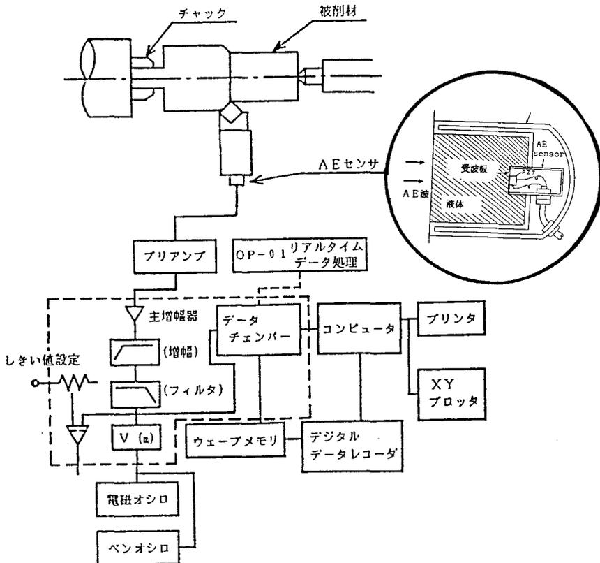
図II. 5.1 実験装置の概略
