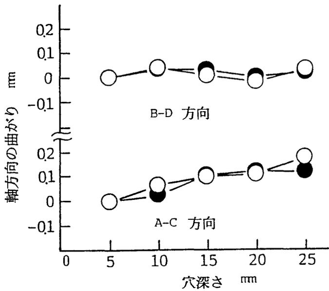
図 I. 4.1.2 連続送り切削による穴の曲がり
