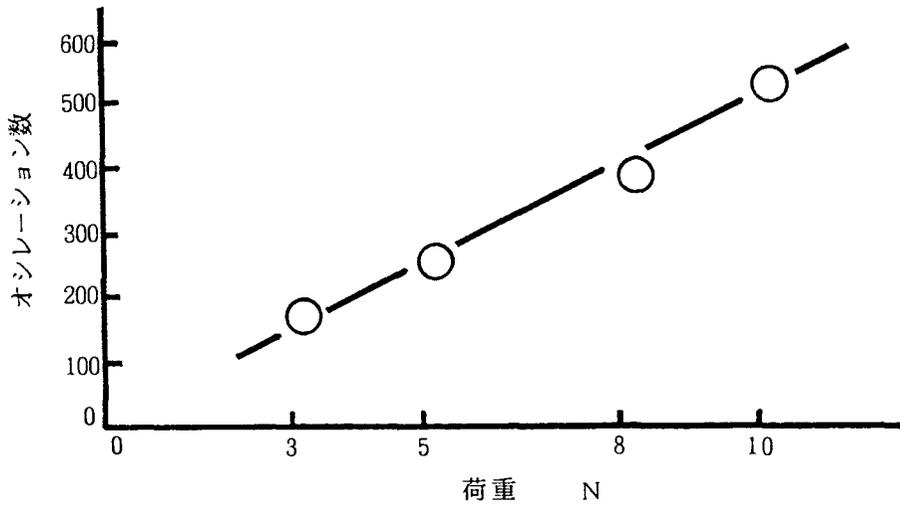
図II. 5.15 摩擦面に垂直方向の荷重とAE信号との関係
