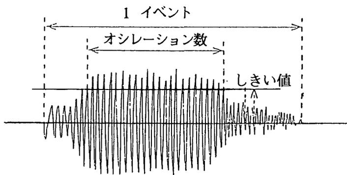
図II. 2.3 しきい値設定によるAE信号の取り込み
