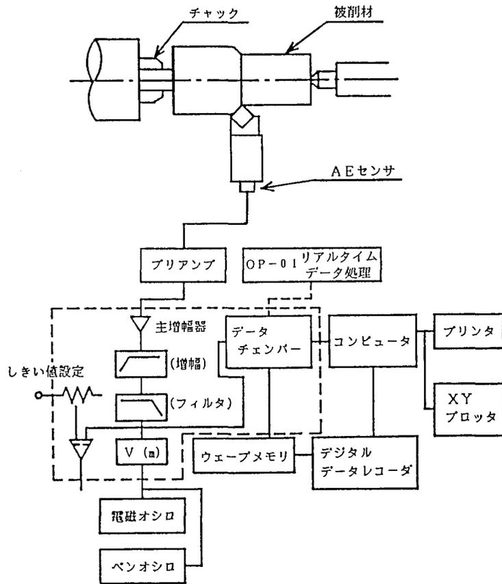
図II. 3.1 AE信号の計測システム
