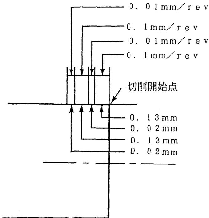
図 I. 2.3 間欠減速送りの図解
