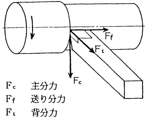
図Ⅱ. 5.10 工具に作用する切削3分力
