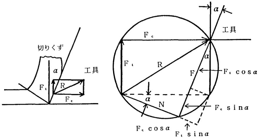
図II. 5.16 切削機構図
