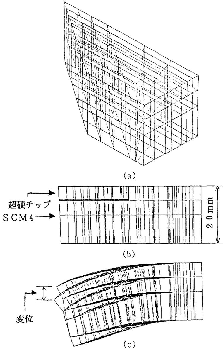
図 I. 3.14 有限要素法による工具刃先の変位
