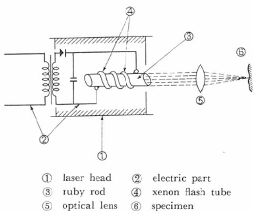
cmであり、両端は平行平面の反射鏡で、一方が反射率100%，他方が99%である。このルビーブルの周囲には、 $\text{Cr}^{3+}$ 原子の励起に必要な光を提供するキセノン閃光ランプがある。
