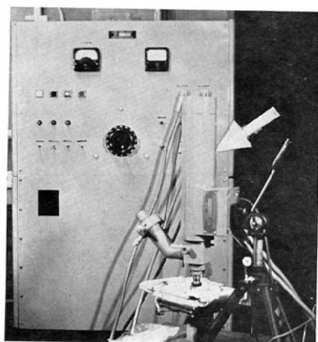
くで、その構造はレーザー光の発振部であるレーザーヘッドと、励起用キセノン管の電源部から成り立つてゐる (Fig. 2)。レーザーヘッドの内面は反射鏡となつておらず、キセノン闪光ランプからの光をむだなくルビーに吸収させるようになつてゐる。中心部のルビーの母体は、0.05%程度のCr<sub>2</sub>O<sub>3</sub>を含んだAl<sub>2</sub>O<sub>3</sub>の結晶で、ピンクルビーと称せられ宝石のそれよりわずかながら色が薄い。ルビーの形は円筒状で直径約1cm、長さ約15
