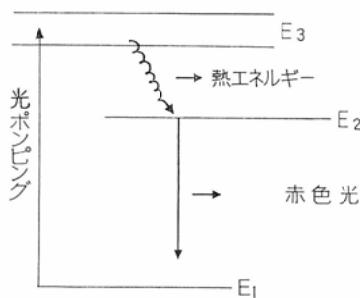
底準位に降下する。この赤色光が準安定準位にプールされている他の $\text{Cr}^{3+}$ を刺激して瞬間的に全ての $\text{Cr}^{3+}$ を誘導放出させることになり、6943Åの赤色光の急激な放出がおこる。この誘導放出された赤色光は、ルビー結晶内の反射鏡によって往復し、位相が整えられる。即ちルビー結晶は共振器として作用し、その間に光は一層強力なものとなり、ある一定量に達し、共振器の損失に打ち勝つと、一度に瞬間的に反射率99%のルビー結晶面から赤色光として外部へ発振される。これがルビー発生装置から発振されるレーザー光である。
