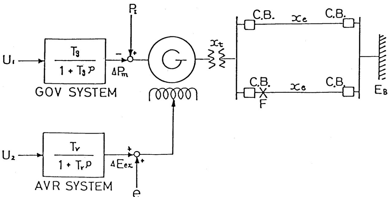
第 4. 1 図 調速機と AVR 制御系を含む一機 - 無限大母線系統
